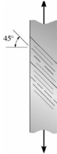
Figura 3 – Linhas de Lüder em uma tira de aço doce no seu escoamento (BEER FP E JOHNSTON, 1995).
