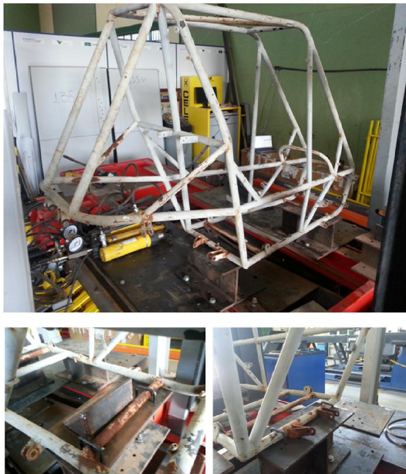
Figura 55 – Modelo fixo e detalhes da fixação dianteira e trazeira.
