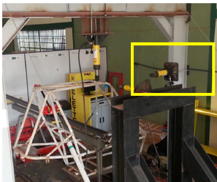
Figura 63 – Fixação pistão de atuação frontal.
