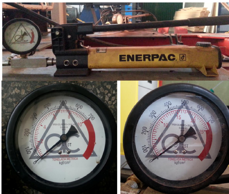
Figura 52 – Atuador e relógio com sua escala.
