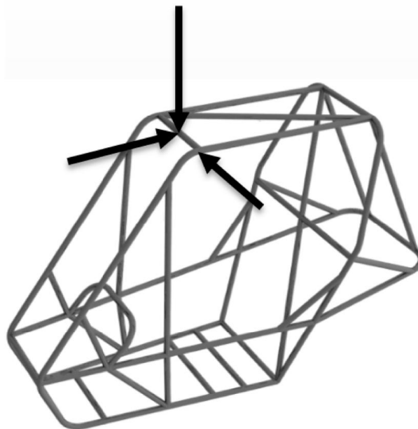
Figura 14 – Posicionamento das cargas aplicadas.
