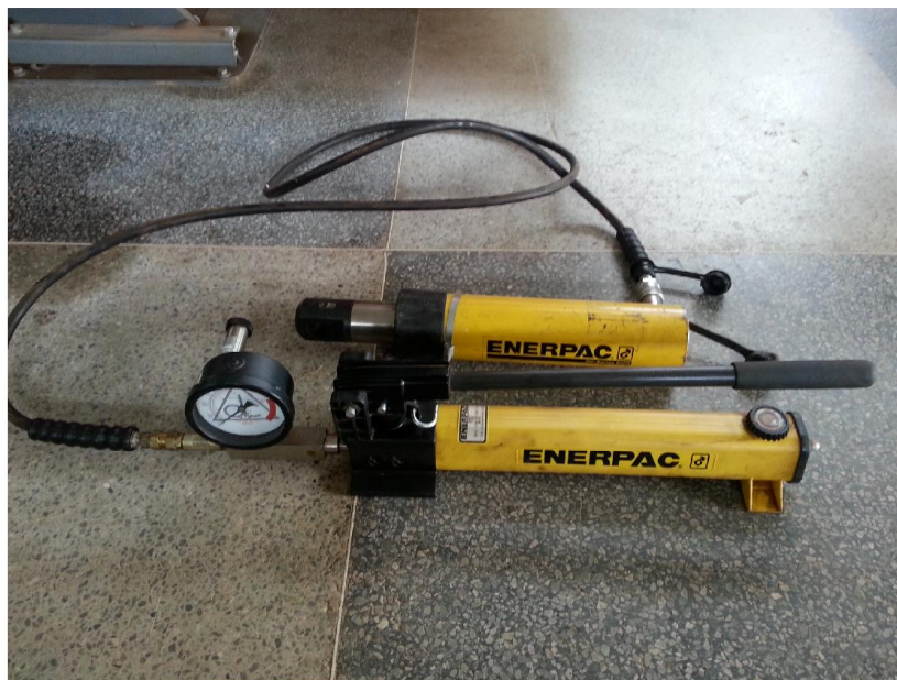
Figura 56 – Pistão e atuador disponível para ensaio de cargas.
