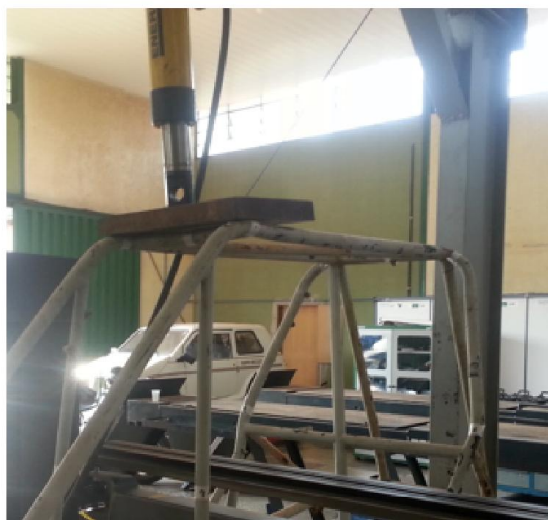
Figura 66 – Situação onde houve deslocamento do pistão.
