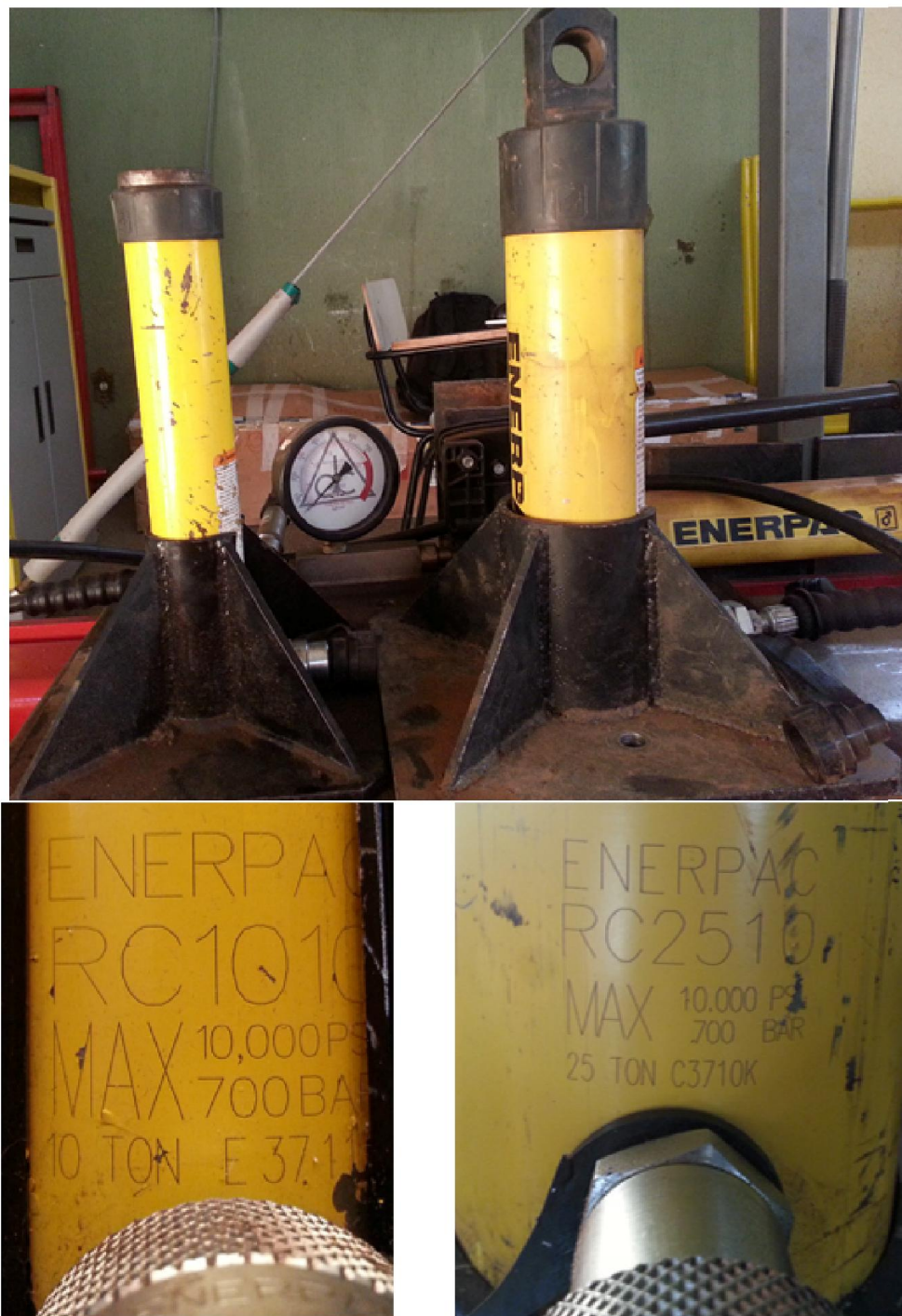
Figura 50 – Pistões hidráulicos e seus limites disponíveis.
