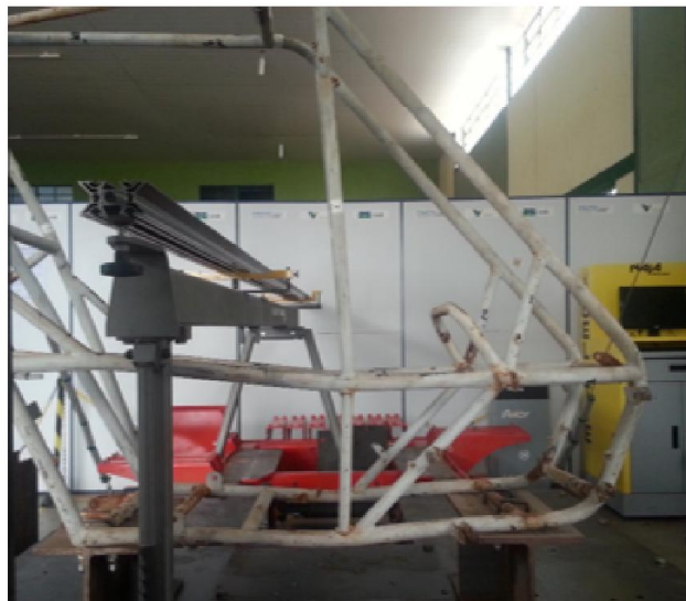
Figura 67 – Deslocamento permanente visível.
