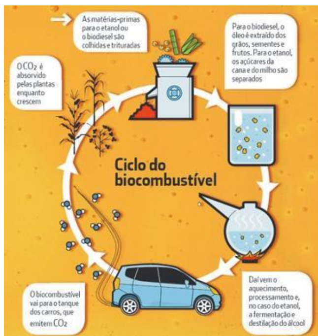
Figura 11: Esquema do ciclo de biocombustível
