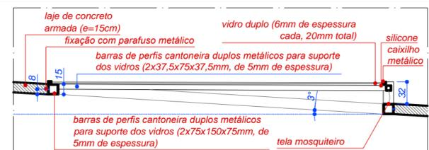
detalhe claraboia (corte zz) - esc.: 1:50
