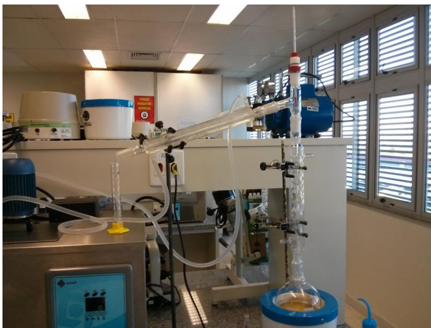
Figura 3: Foto do processo de destilação do fermentado alcoólico de mandioca
