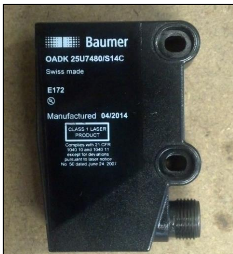
Figura 3.15 - Sensor óptico Baumer (OADK 25U7480).
