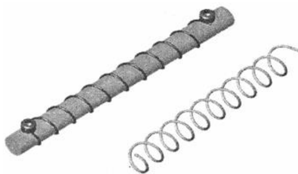
Figura 3.2 – Modelo de instrumento utilizado para a fabricação de molas em SMA (Shape Training Tutorial, 2004).
