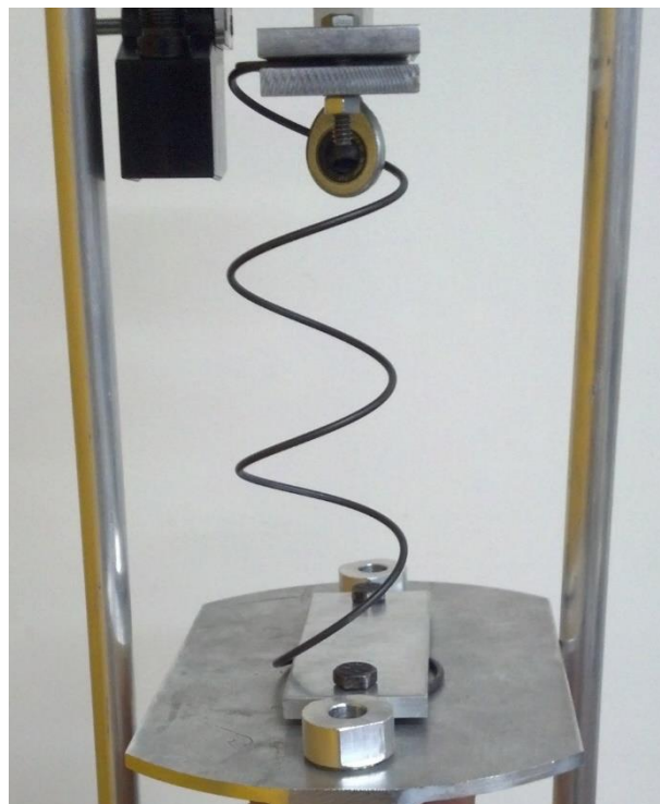
Figura 3.9 - Fixação da mola.
