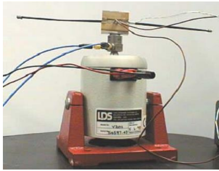
Figura 2.9 - Absorvedor dinâmico de vibrações desenvolvido por Rustighi et al. (2005).
