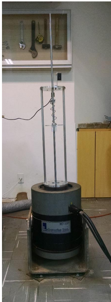
Figura 3.25 - Estrutura para a realização de ensaios dinâmicos.
