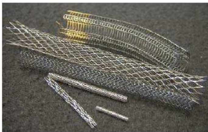
Figura 2.3 - Dispositivos auto expansivos com memória de forma (Nogueira, 2009).
