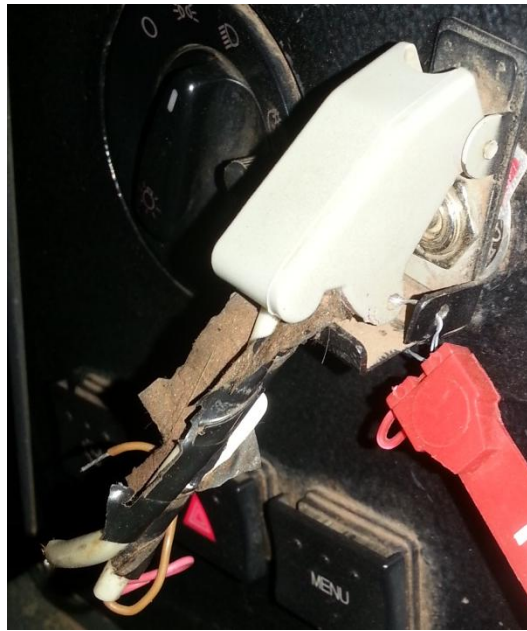
Figura 25 - Chave de emergência com o seu acionamento burlado
