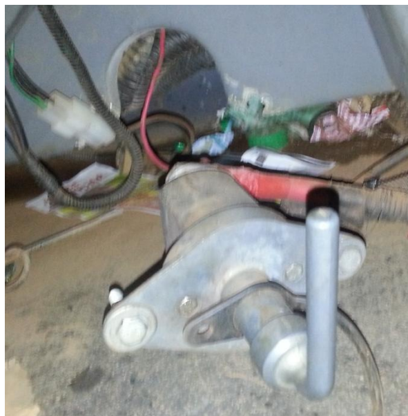
Figura 24 - Chave geral quebrada do suporte
