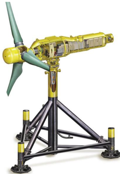
Figura 5.6 – Turbina maremotriz da Rolls Royce com base tipo tripé. (Westislay Tidal, 2014)
