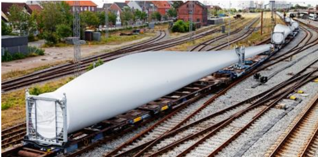
Figura 3.1 - Trem transportando as pás de uma turbina eólica. (Fonte: Lovatto, 2012)
