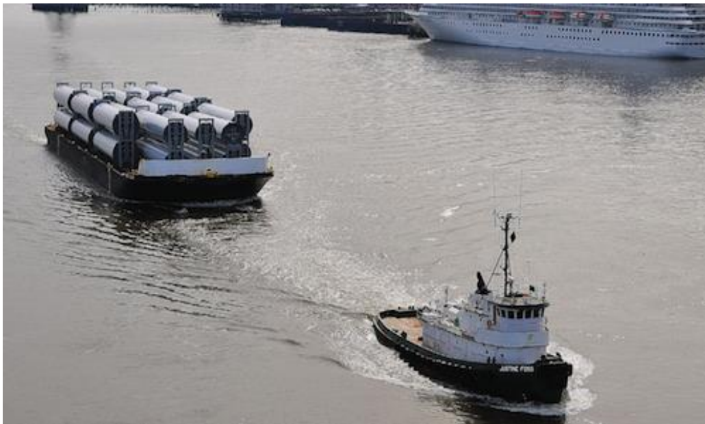
Figura 3.4 – Ilustração do transporte aquaviários de partes das torres de aerogeradores realizado por rebocador.
