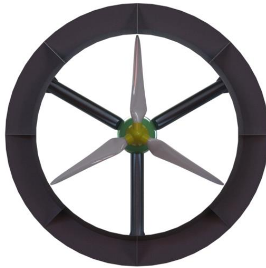
Figura 6.8 - Vista frontal do conjunto difusor-turbina.
