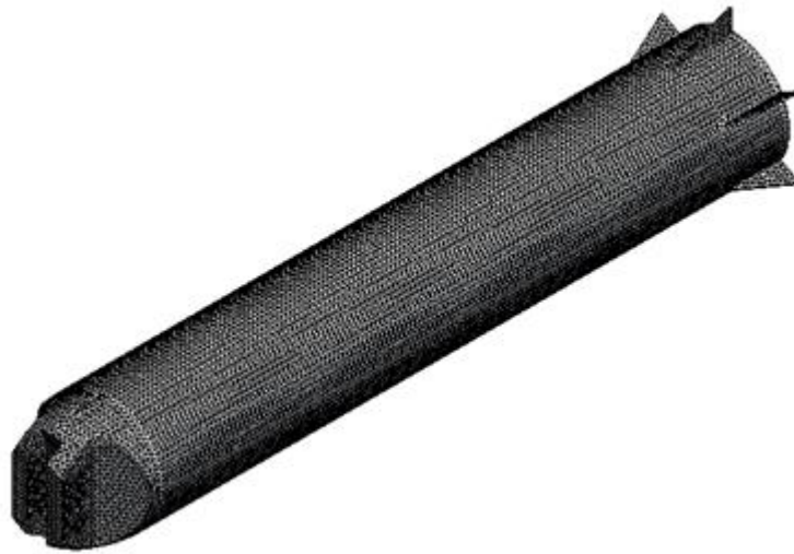
Figura 2.37 - Malha gerada para o estudo da suporte superior.
