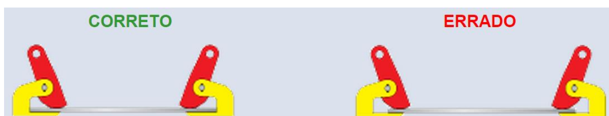
Figura 4.25- Ilustração do posicionamento da chapa e do acessório (Fonte: RUD, 2014)
