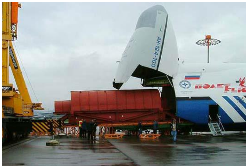
Figura 3.7 - Transporte aéreo de uma turbina da Alstom ( http://goo.gl/ZLqySX , acessado em 16 de maio de 2014)
