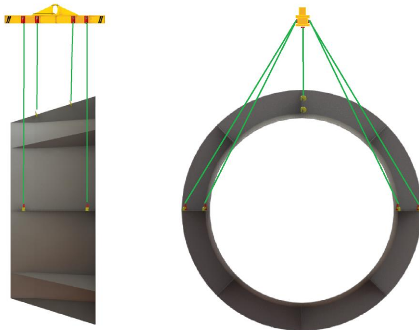
Figura 4.24 – Ilustração do esquema de amarração do conjunto gerador com difusor que deve utilizar os Pega-Chapas, lingotes, ganchos e travessão.
