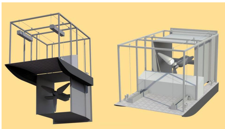
Figura 5.12 - Tipo flutuador com içamento independente
