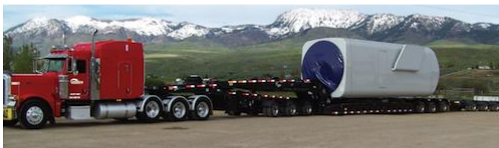
Figura 3.3 - Nacele de uma turbina eólica. ( http://goo.gl/tPUDAx , acessado em 16 de maio de 2014)
