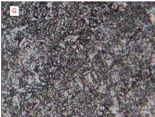
G – TTNormalizado Longitudinal Aumento 100x (Nital 10%)
