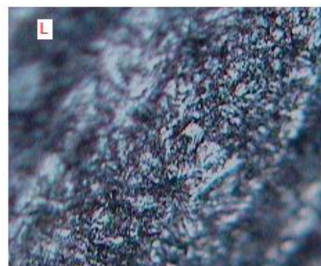
2 – TTRecozido Longitudinal Aumento 200x (Nital 10%)
