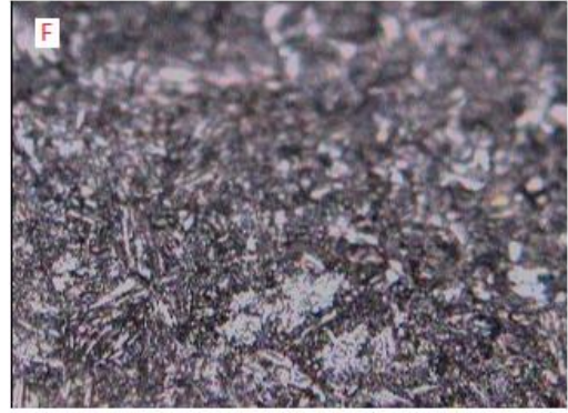
F – TTNormalizado radial Aumento 200x (Nital 10%)
