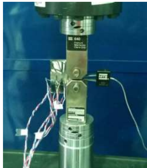
Figura 63 - Extensômetros e fiação colados no corpo de prova.
