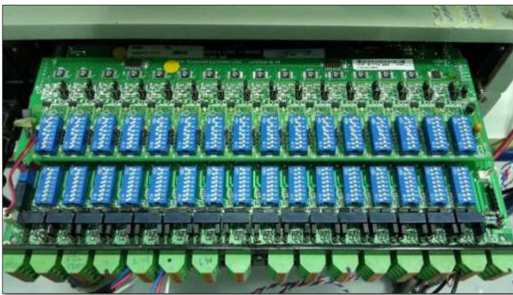
Figura 64 - Indicação das resistências para Shunt na placa 1 do ADS.
