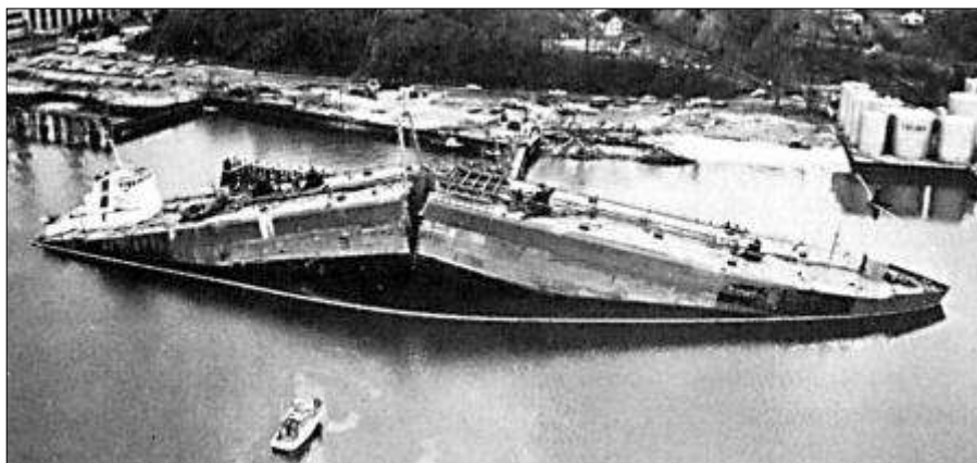
Figura 2 - Fratura frágil ocorrida em um navio de carga Liberty que separou o navio em duas partes em 1941. Fonte: (ANDERSON, 2005)
