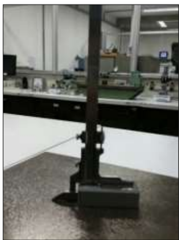
Figura 32 - a) Riscador padrão para marcação no corpo de prova. b) Corpo de prova marcado.
