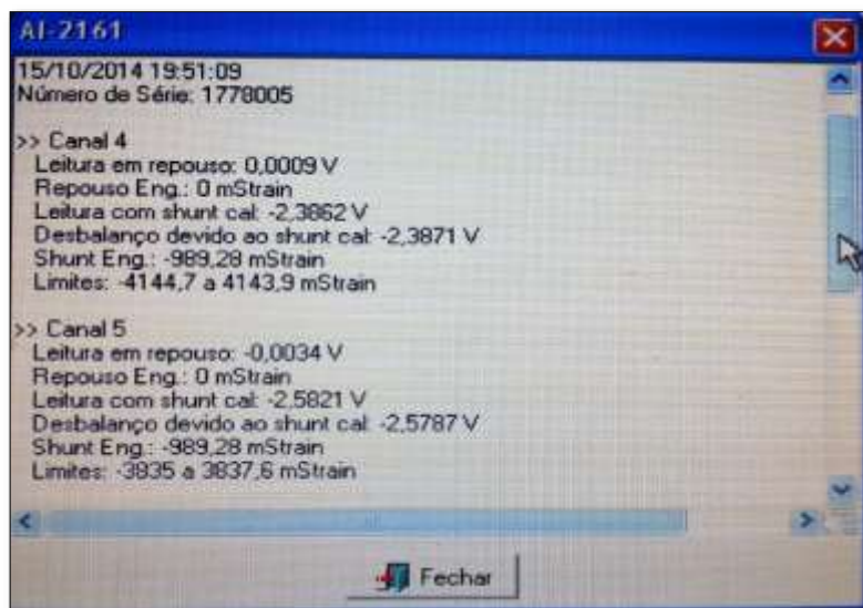
Figura 69 - Relatório de calibração com ShuntCal.
