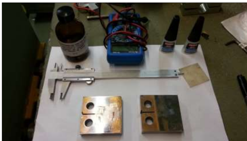
Figura 58- Materiais utilizados para colagem dos extensômetros no CP.
