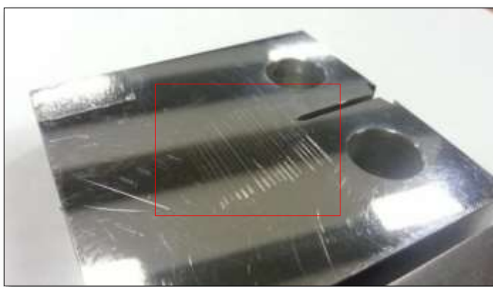
Figura 32 - a) Riscador padrão para marcação no corpo de prova. b) Corpo de prova marcado.
