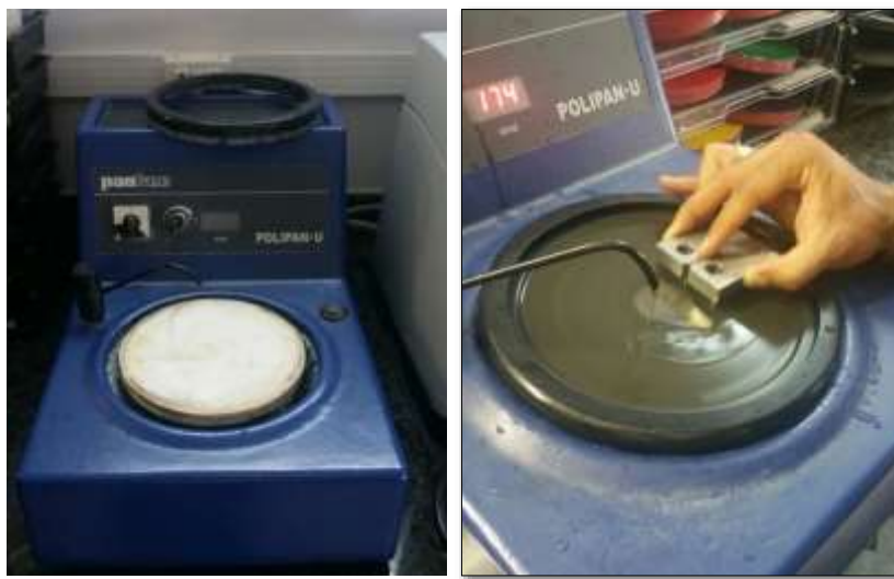
Figura 30 – a) Equipamento para o processo de lixamento. b) Corpo de prova sendo lixado.
