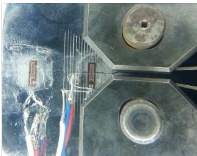
Figura 40 - Acompanhamento do crescimento da trinca pelo método ótico.
