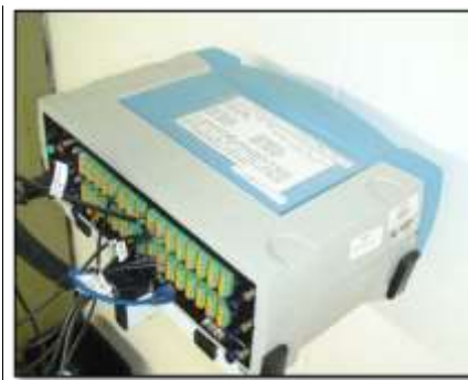
Figura 38 - Sistema de Aquisição de Dados ADS-2000 -Lynx Tecnologia. Fonte: (FADEL, 2010)
