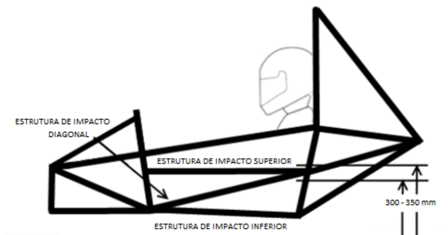
Figura 2.11: Estruturas de impacto lateral [7]
