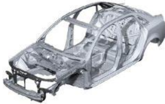
Figura 2.6: Chassi monocoque de um carro de produção. [9]
