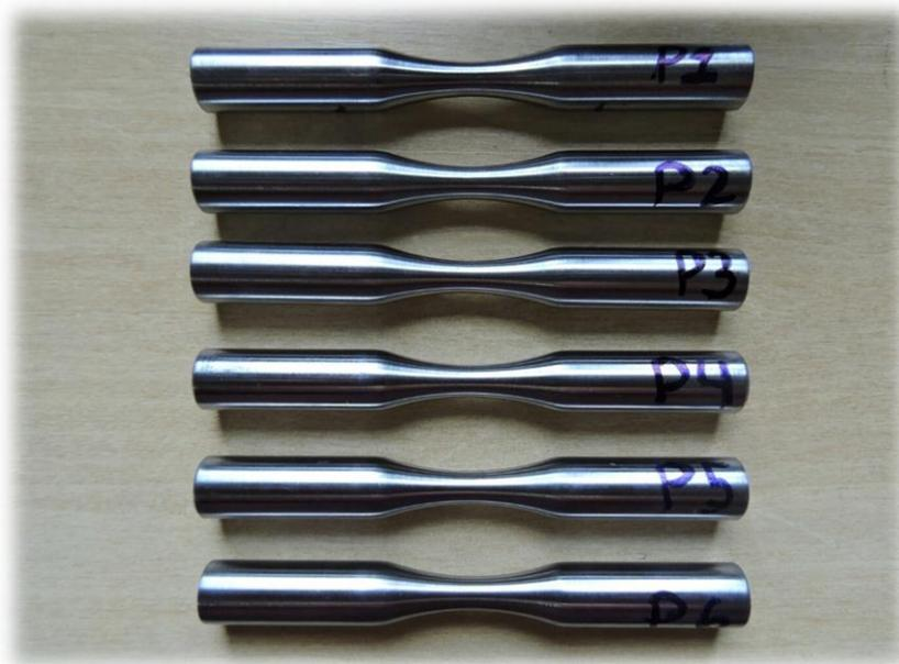
**Figura 13 - Corpos de prova de seção cheia de diâmetro útil 6,35mm – polidos**
