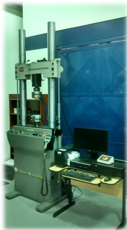
**Figura 3 - Máquina de ensaios de fadiga multiaxiais – MTS 809.10**
