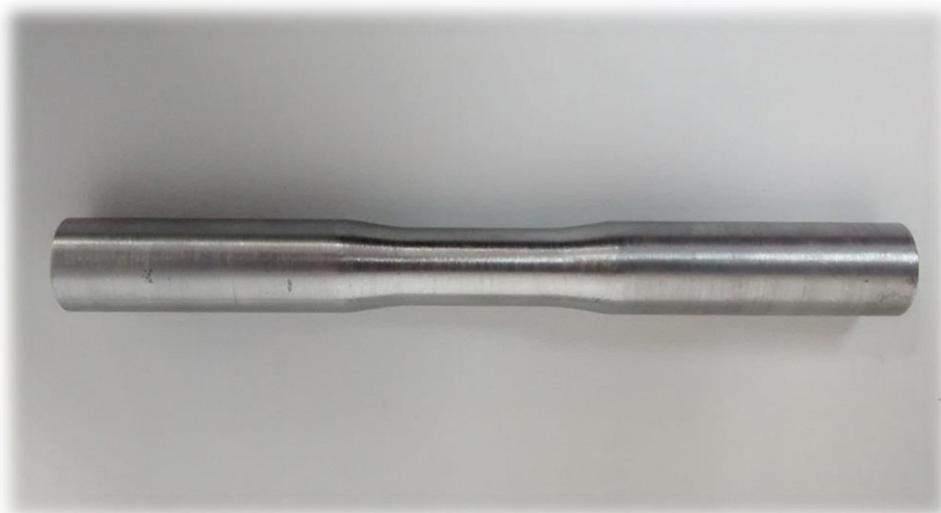
**Figura 11 - Foto do corpo de prova de seção cheia apenas usinado**
