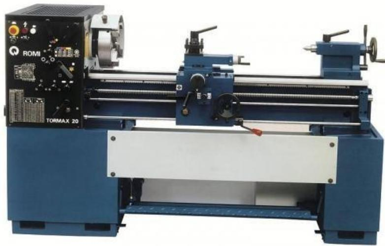
Figura 16 - Torno convencional ROMI modelo TORMAX 20
