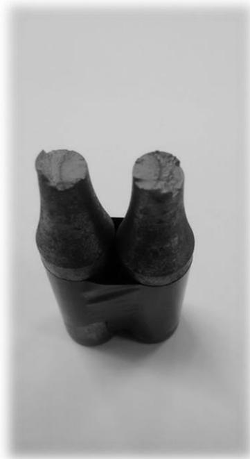
**Figura 42 - Foto do corpo de prova fraturado (usinado) – Terceiro ensaio de fadiga axial**
