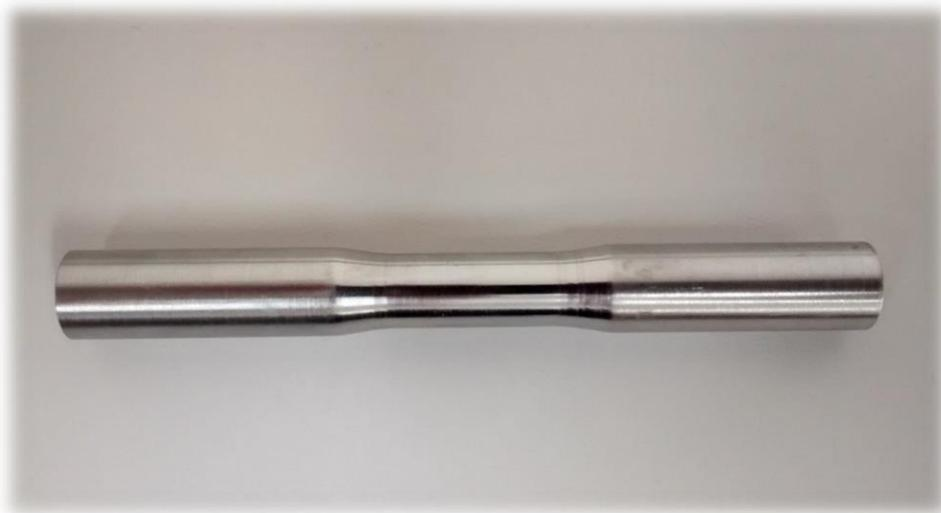
**Figura 10 - Foto do corpo de prova de seção cheia polido**
