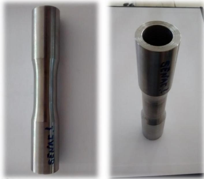
Figura 24 - Corpo de prova tubular com diâmetro de garra de 23.7 mm. (1)
