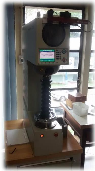
Figura 39 - Foto da máquina de ensaio de dureza Brinell - ZWICK/ROELL - ZHU 250
