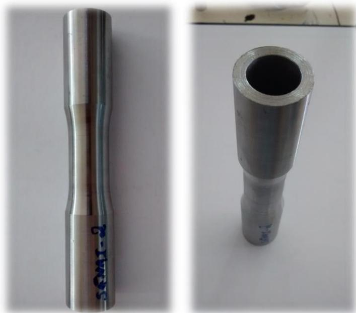
Figura 25 - Corpo de prova tubular com diâmetro de garra de 23.7 mm. (2)
