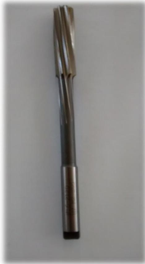
**Figura 18 - Alargador helicoidal DIN-212d utilizado na fabricação**
