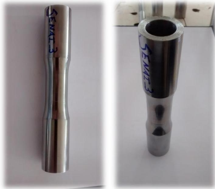
Figura 26 - Corpo de prova tubular com diâmetro de garra de 23.7 mm. (3)
