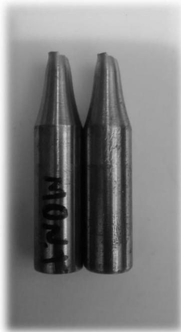
**Figura 37 - Foto do corpo de prova fraturado – Primeiro ensaio monotônico de tração**
