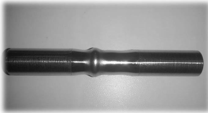
**Figura 31 - Corpo de prova tubular com problema de flambagem**
