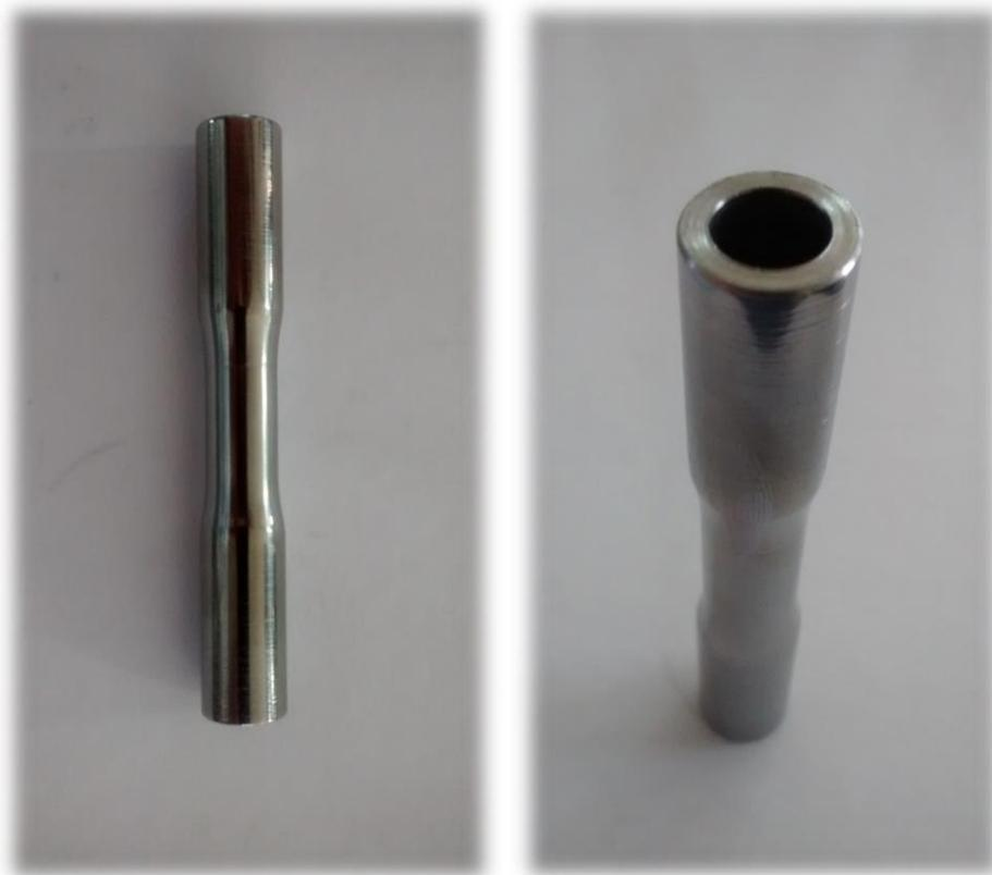
Figura 28 - Corpo de prova tubular usinado
