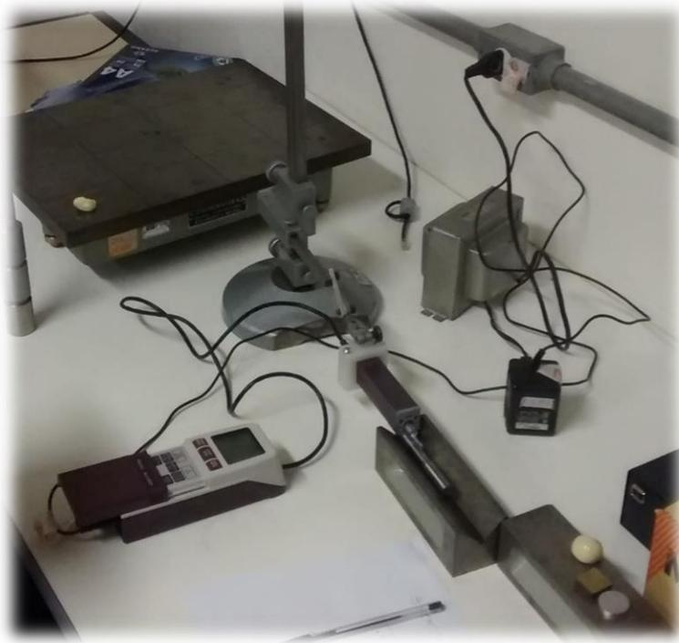
**Figura 29 - Equipamento utilizado para medição de rugosidade – Rugosímetro digital MITUTOYO – SJ201**
