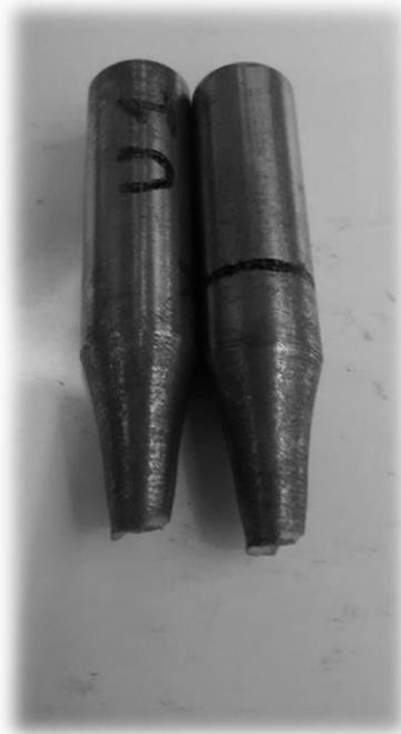
**Figura 38 - Foto do corpo de fraturado - Segundo ensaio monotônico de tração**
