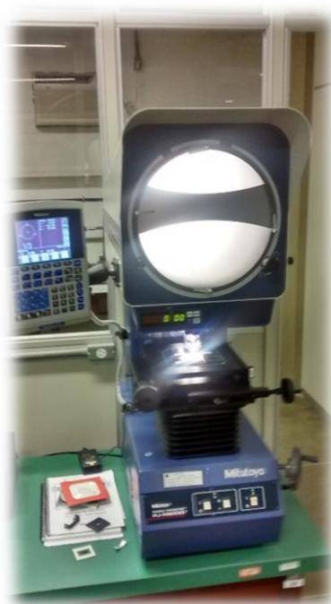
Figura 30 – Máquina projetor de perfil utilizada para a medição dos arcos de circunferência
