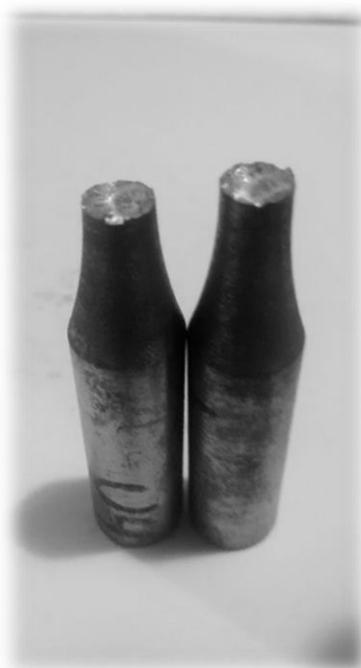
**Figura 45 - Foto do corpo de prova fraturado (usinado) – Ensaio de fadiga multiaxial**
