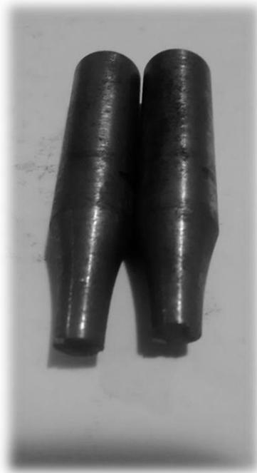
**Figura 41 - Foto do corpo de prova fraturado (usinado) – Segundo ensaio de fadiga axial**
