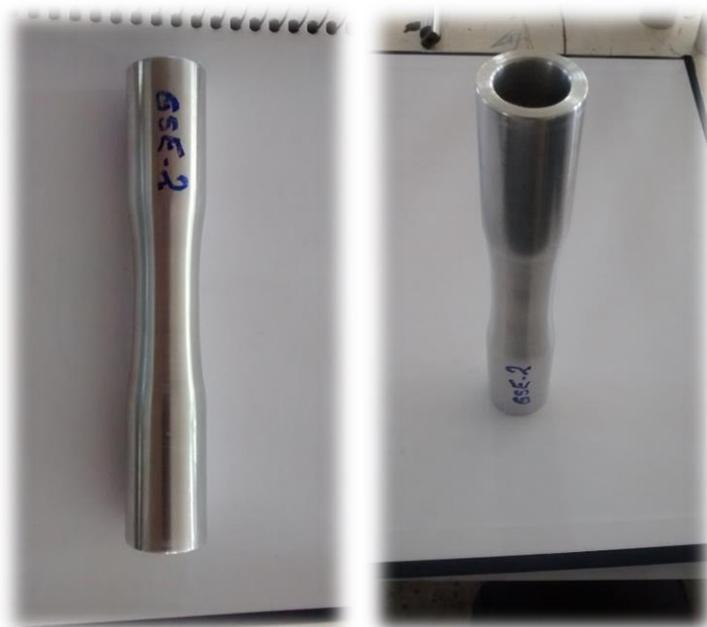
Figura 27 - Corpo de prova tubular com diâmetro de garra de 23.7 mm. (4)
