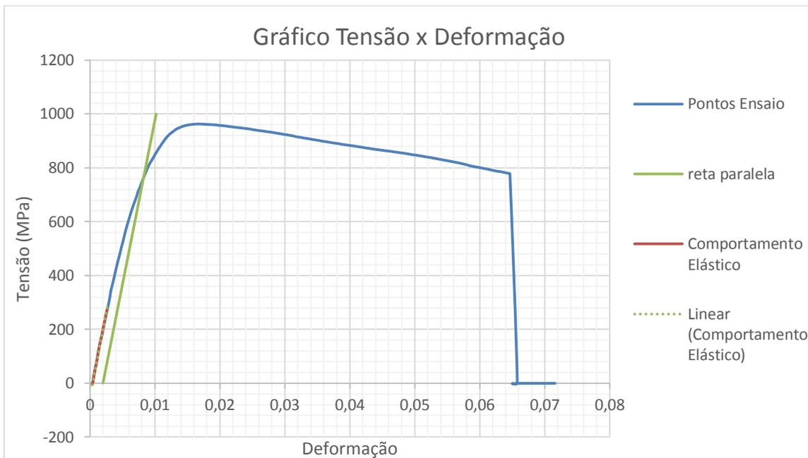
**Figura 35 - Gráfico Tensão x Deformação - Primeiro ensaio monotônico de tração**
