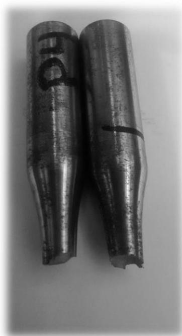
Figura 40 - Foto do corpo de prova fraturado (polido) – Primeiro ensaio de fadiga axial
