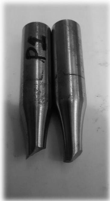
**Figura 43- Foto do corpo de prova fraturado (polido) – Quarto ensaio de fadiga axial**
