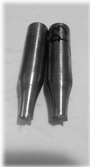
**Figura 44 - Foto do corpo de prova fraturado (polido) – Ensaio de fadiga multiaxial**
