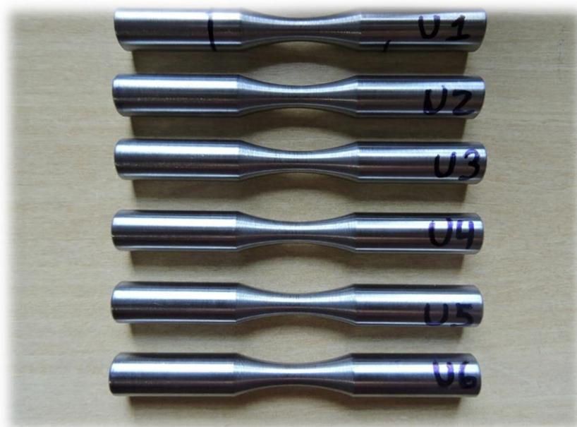
**Figura 14 - Corpos de prova de seção cheia de diâmetro útil 6,35mm – usados**
