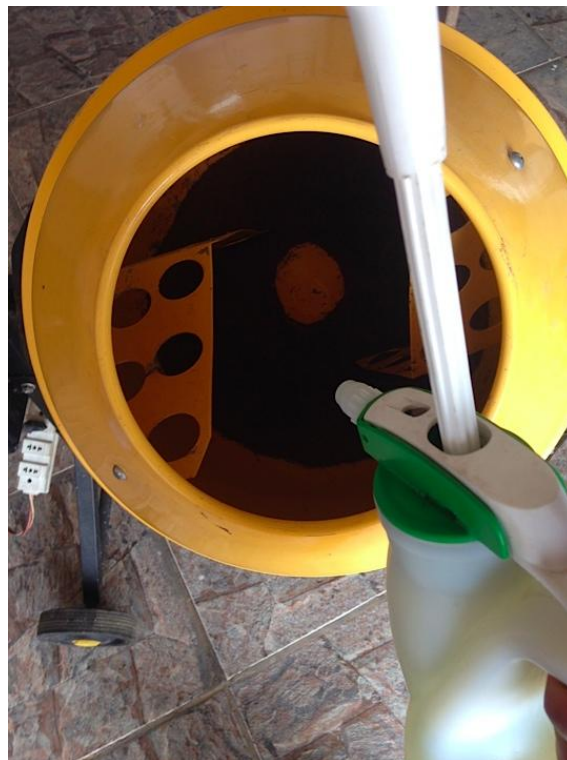
Figura 6. Hidratação da fibra de piaçava com borrifador de pressão manual em um misturador elétrico (betoneira).
