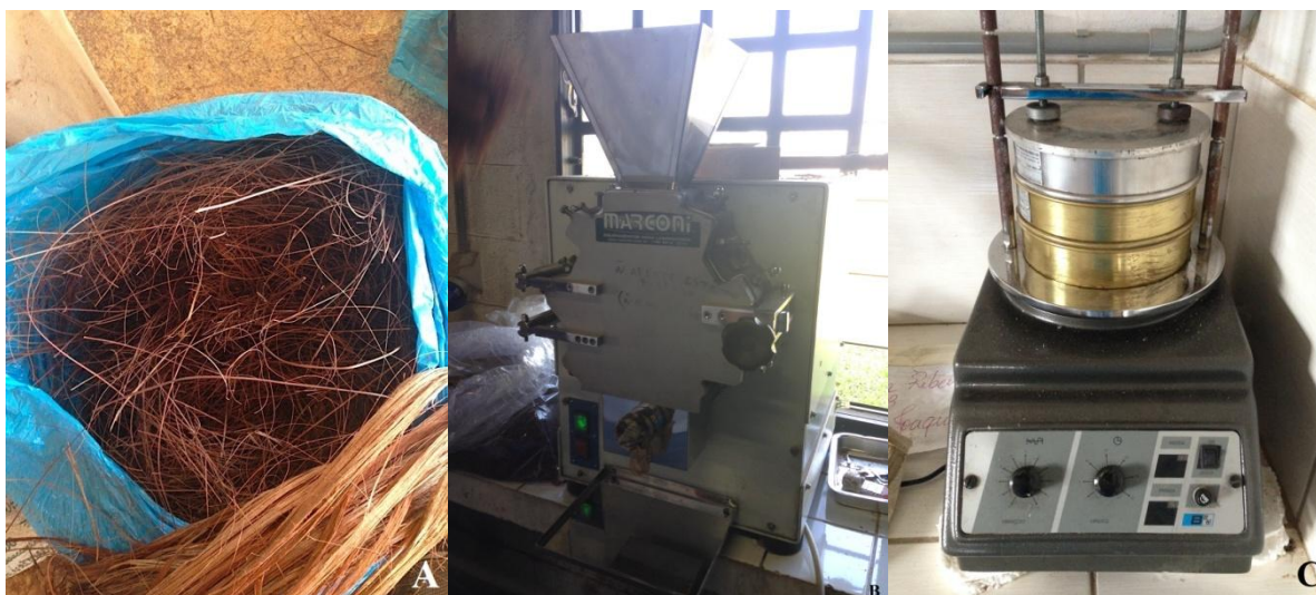
Figura 3. a) fibra de piaçava. b) moinho de facas de laboratório. c) classificador vibratório.
