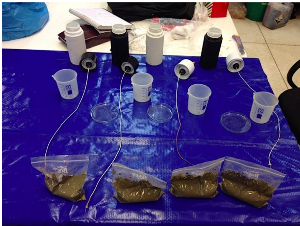
Figura 4. Preparação das amostras para realização do teste de inibição.
