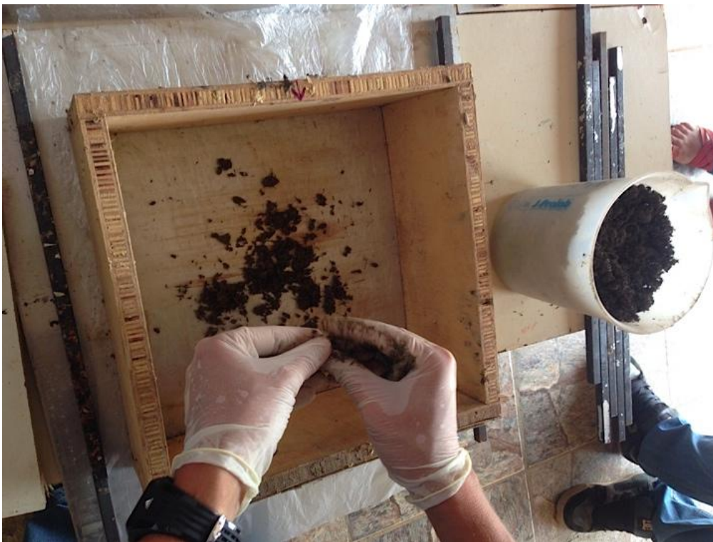
Figura 7. Formação do colchão em um caixa formadora de madeira.
