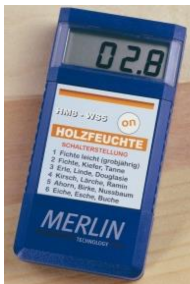
Figura 6. Aparelho capacitivo utilizado para medição de umidade em madeiras, modelo HM8. Fonte: Merlin Technology (2002)
