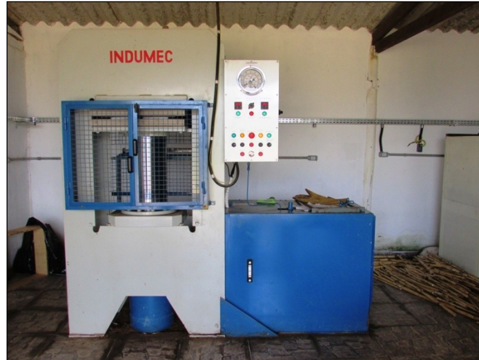
FIGURA 4. Prensa hidráulica utilizada para confecção dos painéis, Laboratório de Engenharia e Tecnologia de Produtos Florestais, FAL – UnB.
