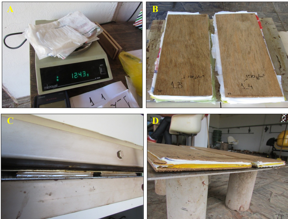
FIGURA 3. Processo de confecção dos painéis LVL: A) Pesagem das sacolas plásticas; B) Preparação dos conjuntos que serão levados à prensa; C) Prensagem dos Painéis à \pm 140\text{ }^{\circ}\text{C} ; D) Resfriamento dos laminados à temperatura ambiente.
