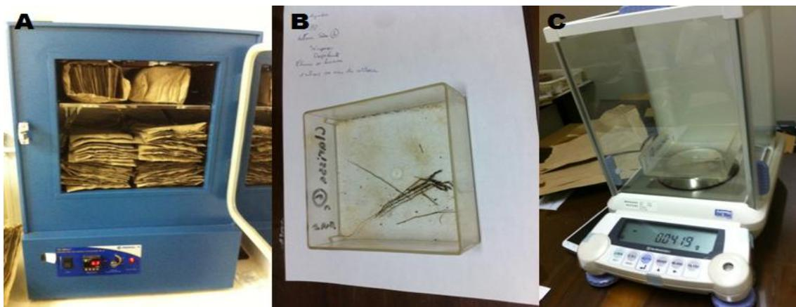
Figura 3 - Determinação da massa seca radicular. A: Estufa com circulação de ar a 65°C; B: Raízes em recipiente para pesagem; C: Balança eletrônica.
