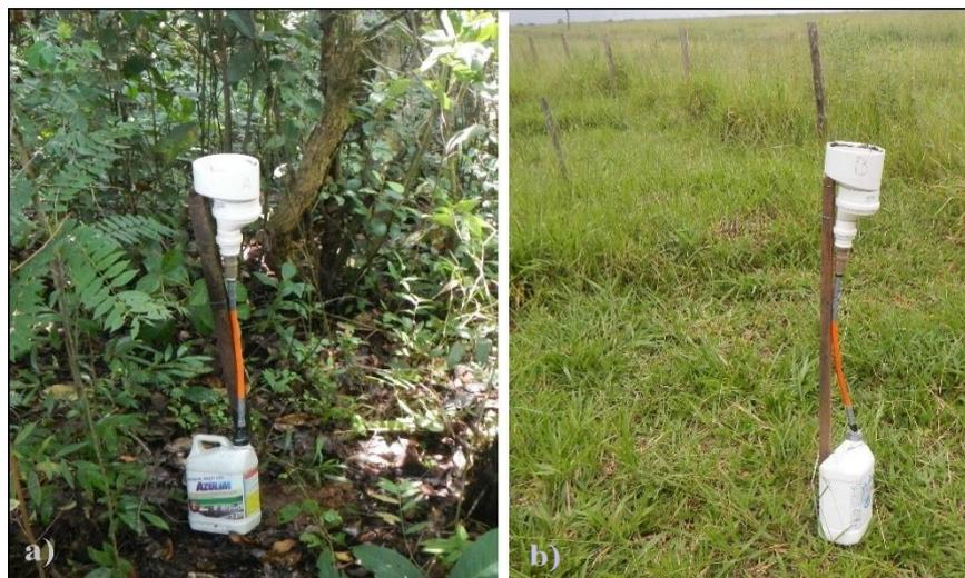
**Figura 3** - Pluviômetros instalados no interior da mata ripária e na pastagem
