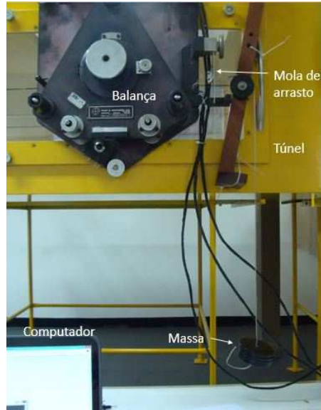
Figura 30. Calibração da balança de túnel de vento
