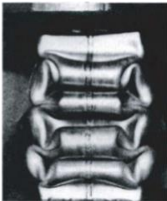
Figure 13 - Mode d'écrasement régulière
