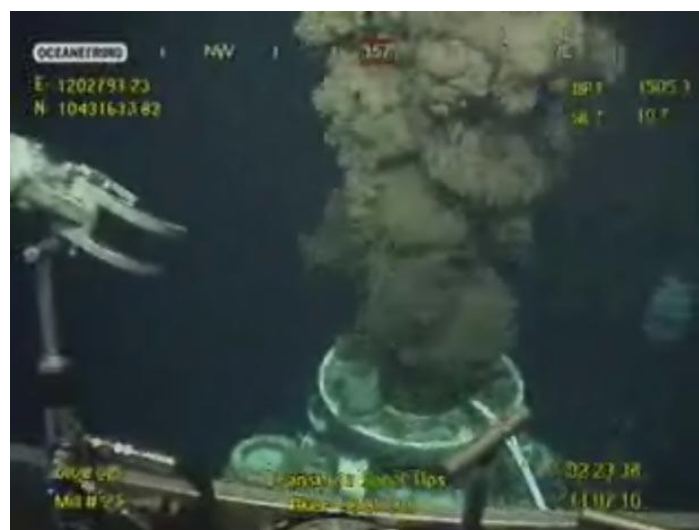
Figura 1. 9 - Vazamento do tubo registrado por um robô. [11]
