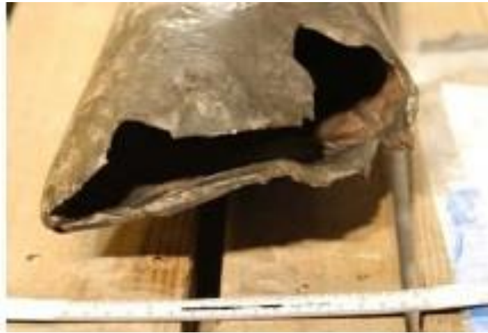
Figura 1. 7 - Tubo partido, mas não selado. [3]
