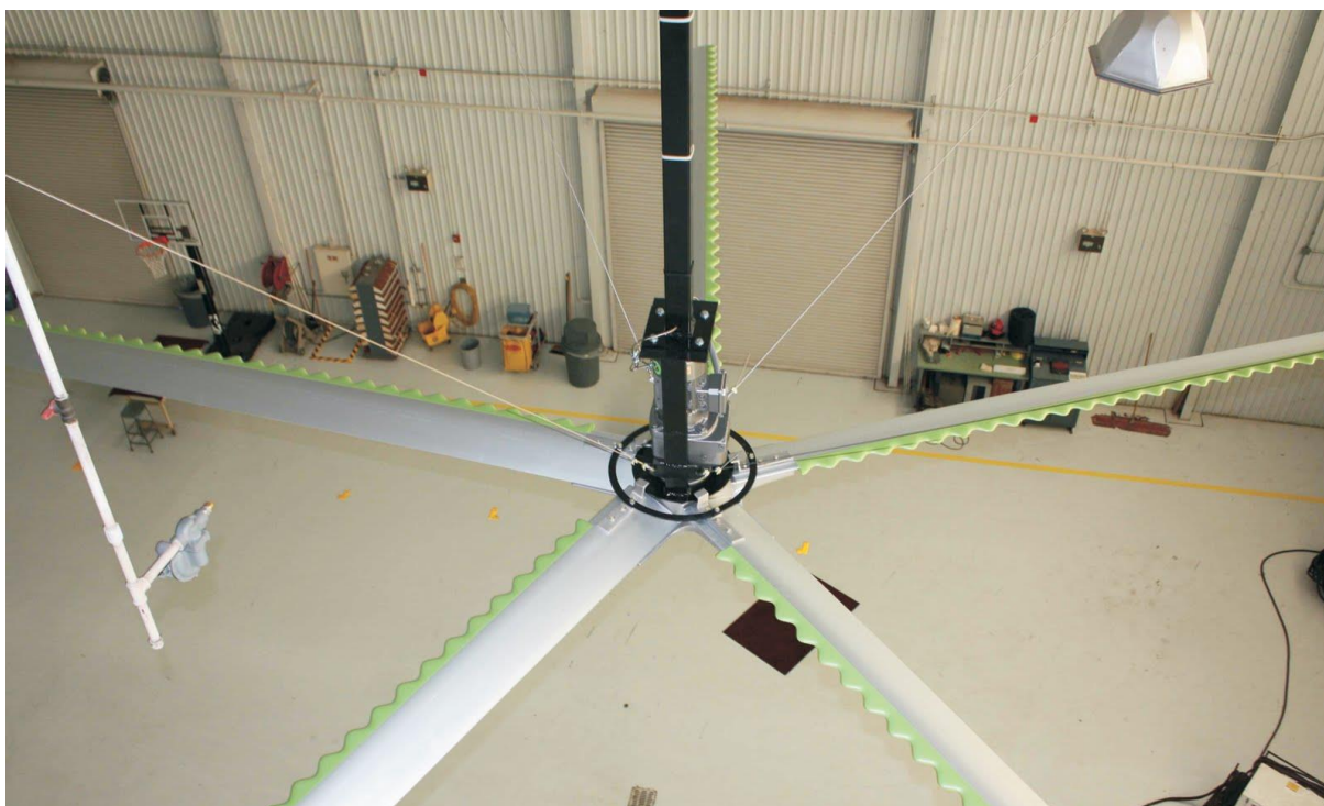
Figura 2.5 - Pás construídas com a geometria jubarte
