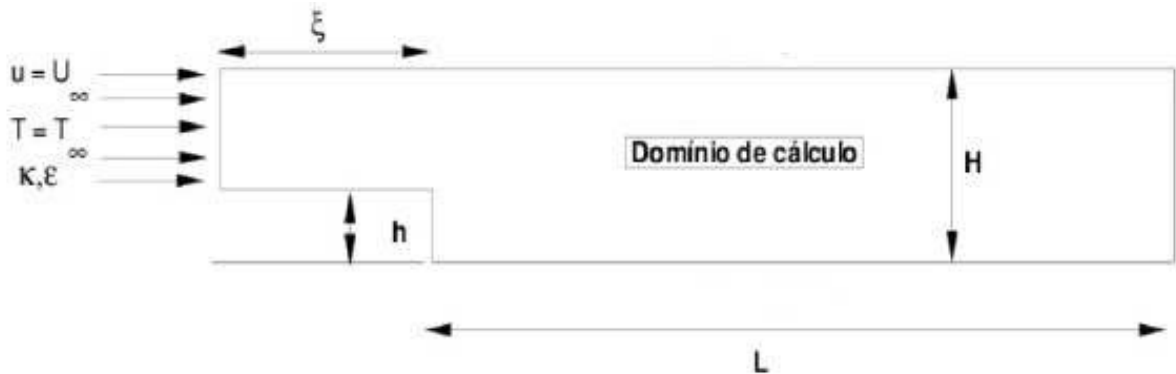
Figura 3.5: Domínio do cálculo para simulação do degrau de Le, Moin & Kim
