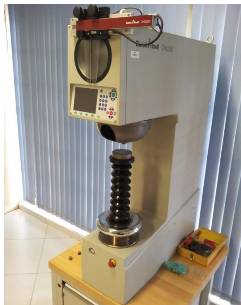
Figura 8 - Durômetro Zwick Roell ZH 250.
