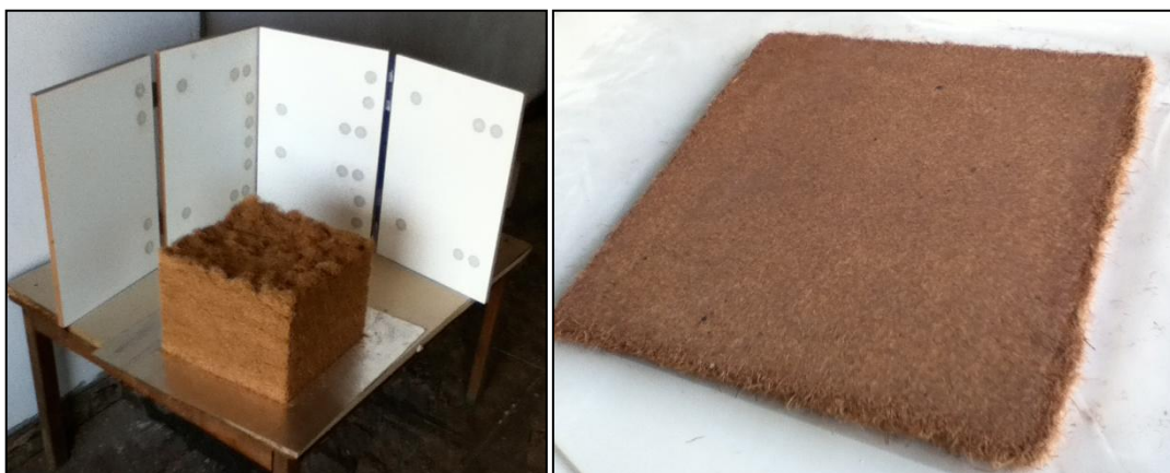
FIGURA 16 – Esquerda : colchão de partículas recém-tirado do molde; Direita : painel recém- prensado.
