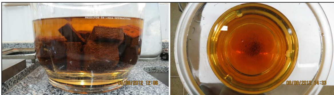
FIGURA 22 – Desprendimento de extrativos durante (Esquerda) e após realização (Direita) dos ensaios de Inchamento e Absorção de água.
