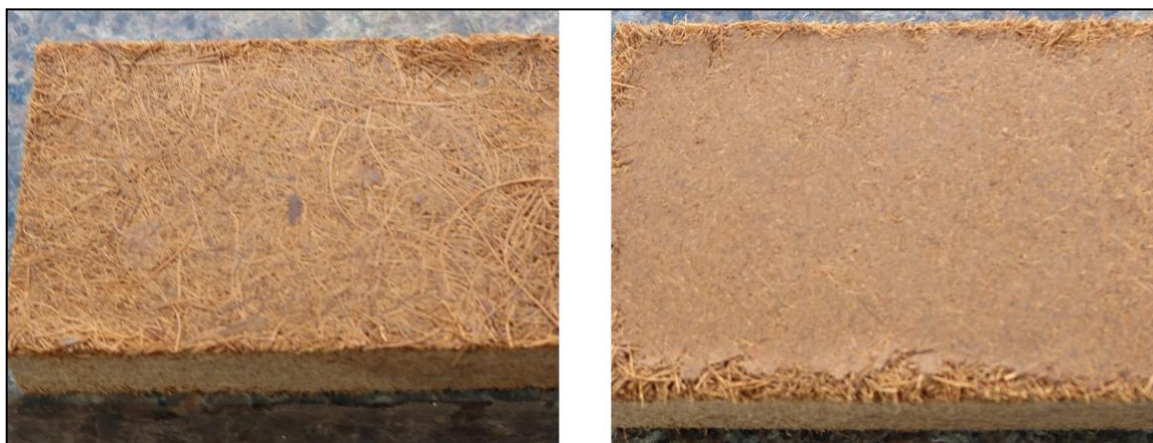
FIGURA 17 – Esquerda : face superior dos painéis; Direita : face inferior dos painéis.
