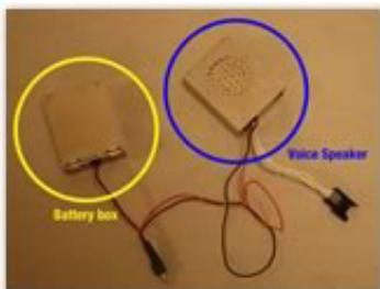
A peça da cabeça equipada com de função de vocal tem um alto-falante de voz e uma caixa de bateria. Estes são removíveis. O alto-falante de voz está posicionado na frente lateral da cabeça, e a caixa de bateria é posicionada na parte de trás.
