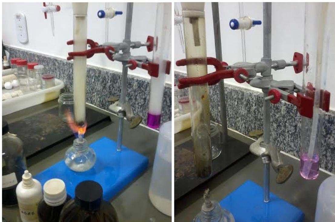
Fig. 1: Decomposição térmica no início e após dois minutos.
