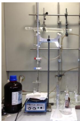
Figura 11 - Esquema para determinação do índice de acidez.
