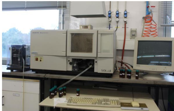
Figura 26 – Espectrofotômetro de absorção atômica usado para determinação do teor de sódio, marca Solar.
