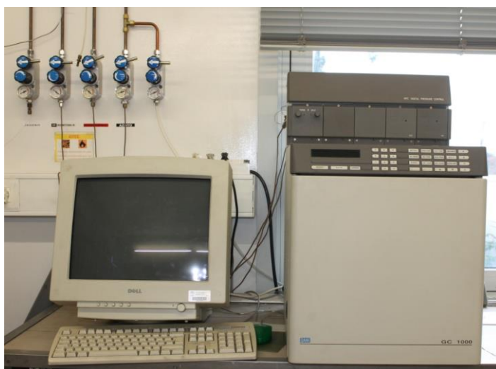
Figura 20 - Cromatógrafo gasoso da marca DANI GC 1000 FPC (DANI Instruments S.p.A.) e respectivo sistema de aquisição de dados.
