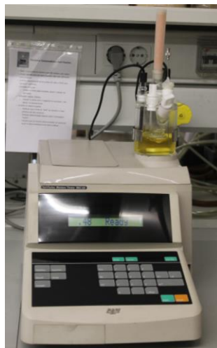
Figura 23 - Equipamento usado para determinação do teor de água através de coulometria - Karl Fischer.
