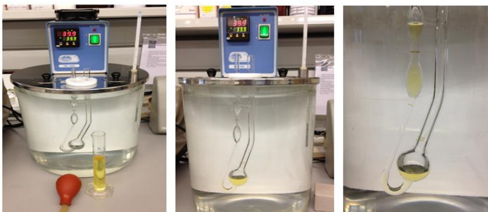
Figura 21 - Etapas da determinação da viscosidade cinemática a 40°C.
