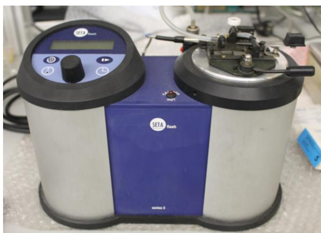
Figura 22 - Equipamento para medição do ponto de fulgor, marca STANHOPE SETA.
