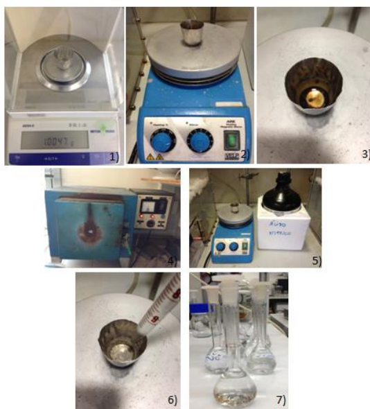
Figura 25 - Processo de preparação da amostra para análise no espectrofotômetro: 1) Pesagem de 1 g de amostra 2) secagem a 370°C. 3) Sólido avermelhado formado após secagem. 4) Mufla 5) Cinzas brancas e ácido nítrico 6) Ataque ácido 7) Diluição em 50 mL.
