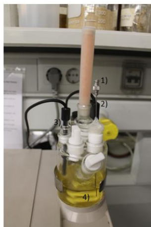
Figura 24 - Equipamento do Karl Fischer: 1) Local para inserção da amostra 2) Bureta e dessecante 3) Eléctrodo de leitura 4) Célula de titulação com reagente/solvente.
