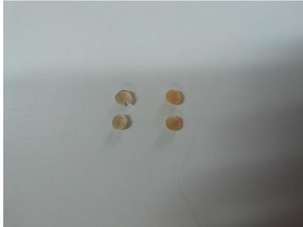
**Figura 10: Reações negativas da enzima peroxidase no tegumento de semente de soja**
