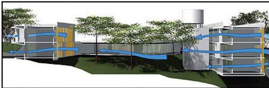
Figura 3.2 – Ação dos ventos através de uma edificação (Casa Ecológica, 2012).
