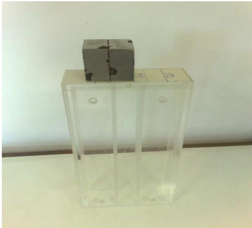
Figura 3.18: Ímã de Neodímio sobre o suporte de acrílico graduado de acordo com os campos utilizados.
