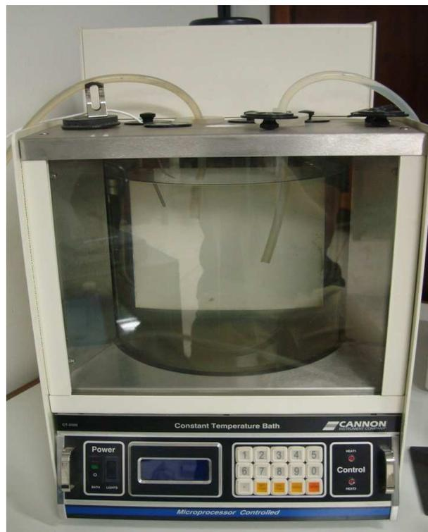
Figura 3.4: Banho térmico com precisã de  $0,001^{\circ}\text{C}$
