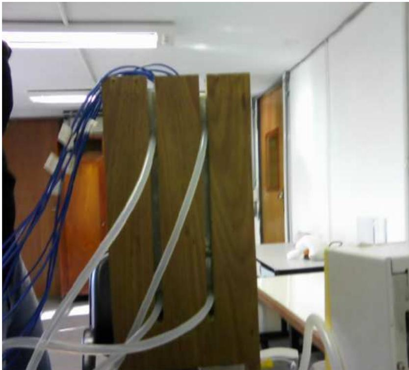
Figura 3.13: Entrada e saída do fluido de recirculação
