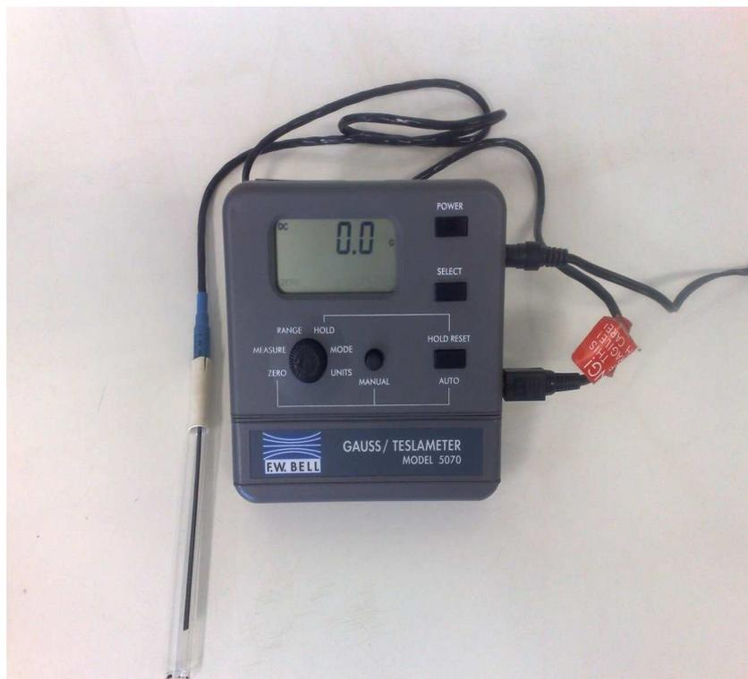
Figura 3.5: Gaussmeter - aparelho utilizado para a medição de campo de indução magnética.
