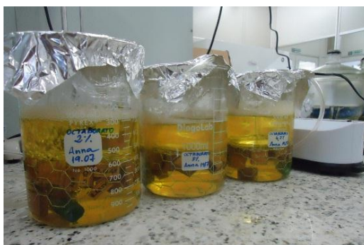
Figura 4. Tratamentos preservativos da espécie Dendrocalamus giganteus com Bórax e TBF.
