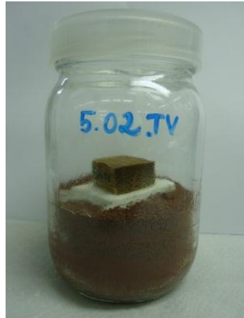
Figura 7. Disposição do corpo de prova sobre a placa suporte no interior do frasco de vidro.
