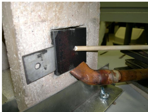
Figura 3.5: Aparato para proteção gasosa feito com tubo de cobre.
