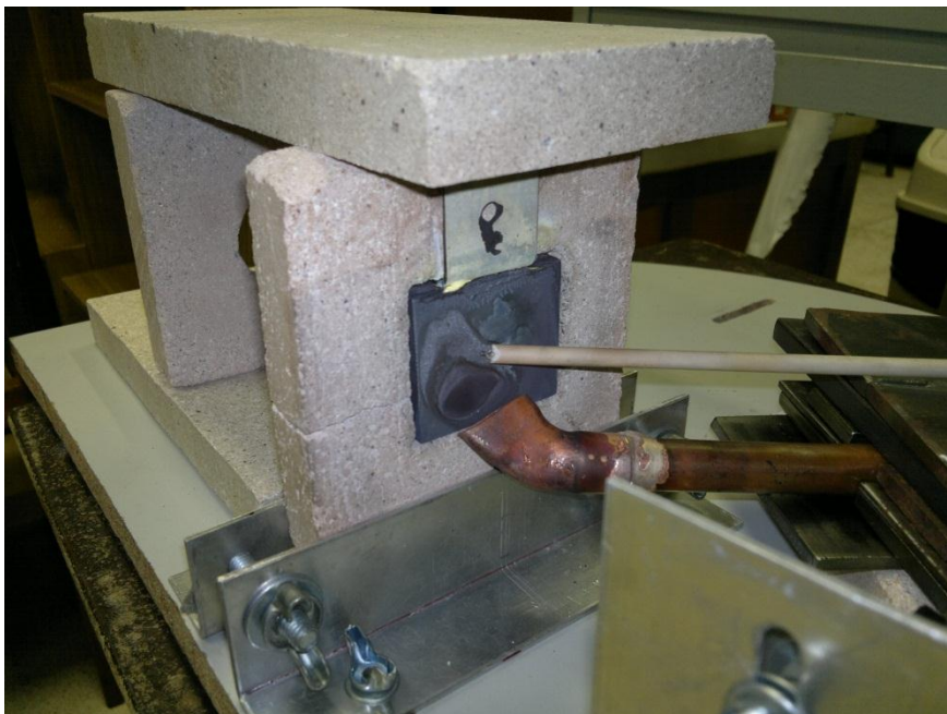
Figura 4.3: Resultado da proteção gasosa após o resfriamento da amostra de aço doce com superfície lixada.
