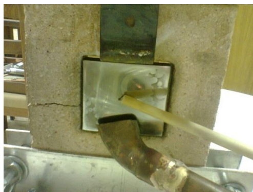
Figura 4.9: Condição da superfície para o aço doce, lixada com lixa 240 antes do ensaio.
