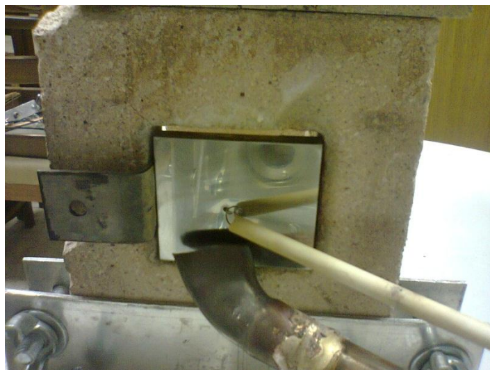
Figura 4.13: Condição da superfície do aço inoxidável martensítico CA-6NM, lixado com lixa 240 antes do ensaio.
