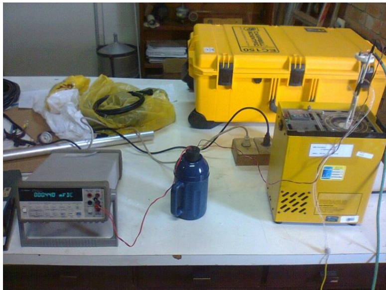
Figura 3.8: Procedimento de calibração do termopar.
