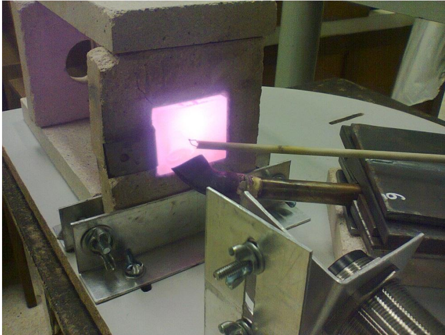
Figura 4.4: Superfície do aço CA6-NM em elevada temperatura revelando menor oxidação em relação ao aço doce com superfície lixada.
