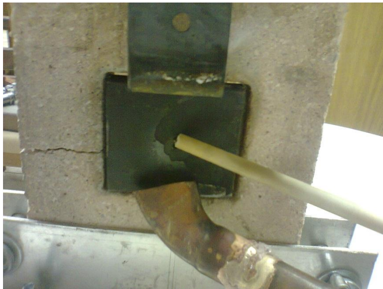
Figura 4.5: Condição da superfície da amostra de aço doce altamente oxidada antes do ensaio.
