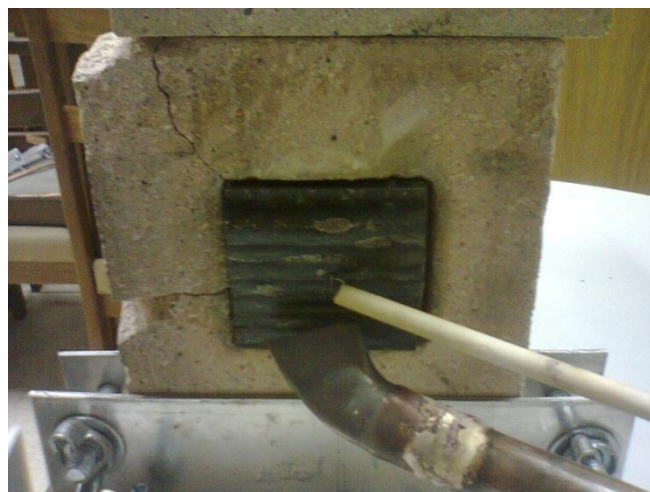
Figura 4.17: Condição da superfície do aço inoxidável de deposição 410 NiMo, como depositado, antes do ensaio.
