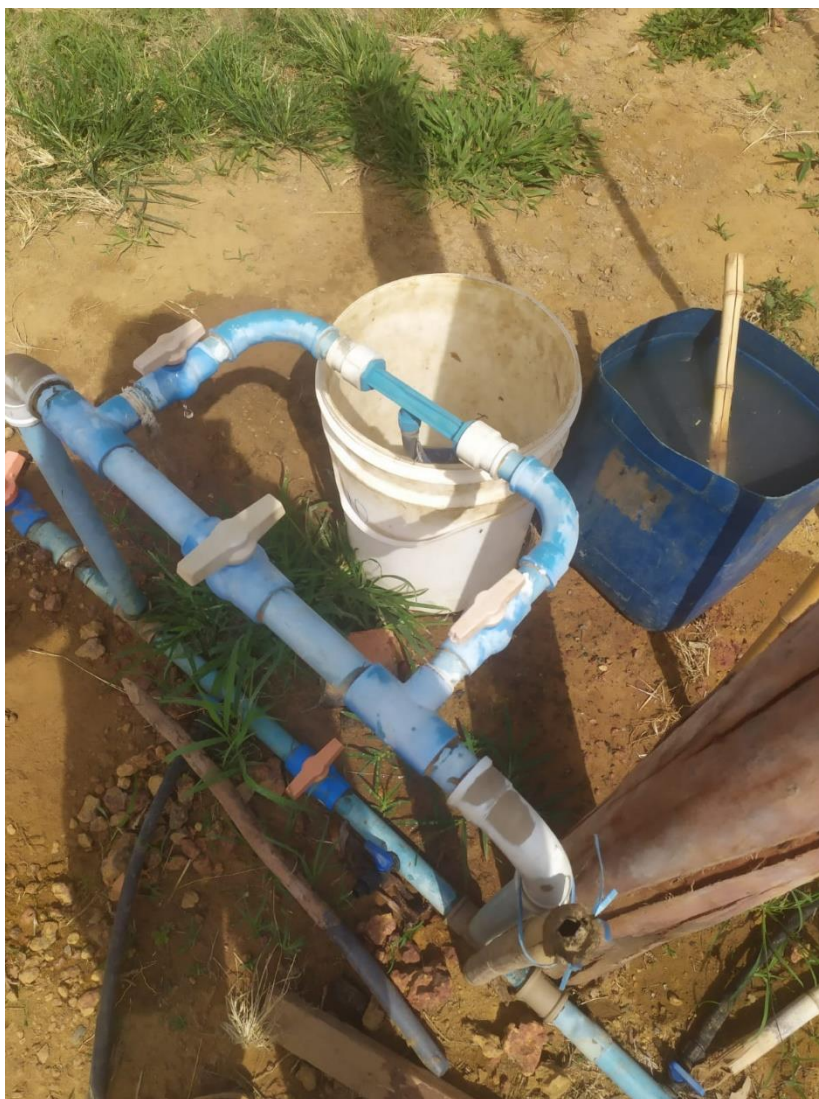
Figura 1. Sistema de injeção de fertilizante no sistema de irrigação do plantio para fertirrigação.
