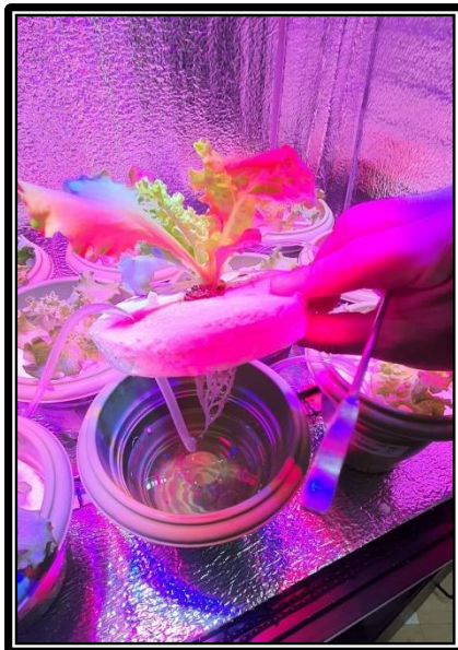
Figura 2. Câmara de crescimento de plantas e sistema de cultivo hidropônico, com aeração. Laboratório de Química e Fertilidade do solo.
