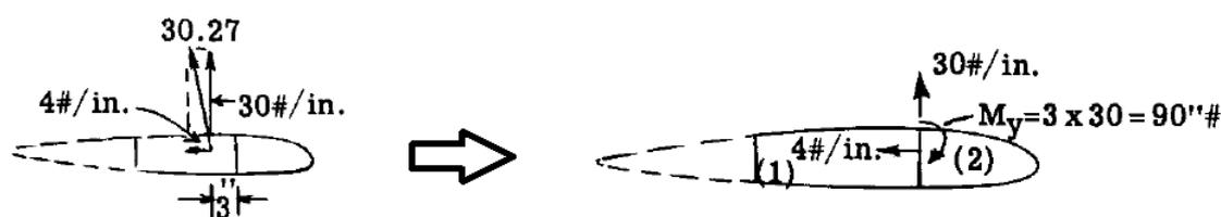
Figura 47 – Células da seção da asa. Adaptado de (BRUHN, 1973)
