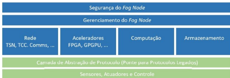
Figura 2.4: Estrutura do fog node proposta pelo OpenFog Consortium [3].
