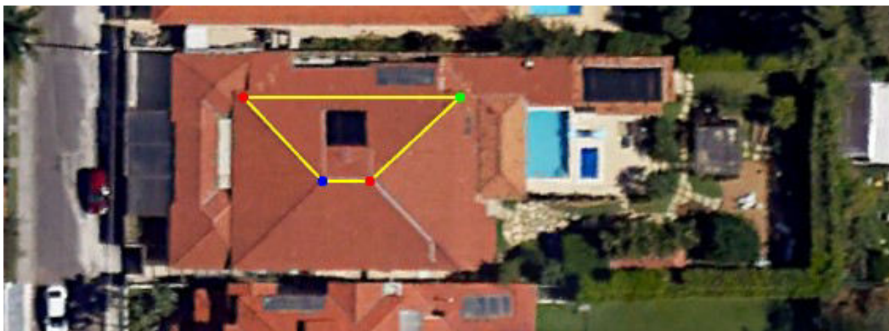
Figura 4.2. Região do telhado escolhida para a disposição dos módulos do Sistema 1 (Google Earth Pro® - 2021)
