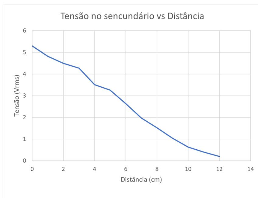
Figura 5.6: Curva tensão no secundário pela variação da distância obtida a partir da Tabela 5.3.
