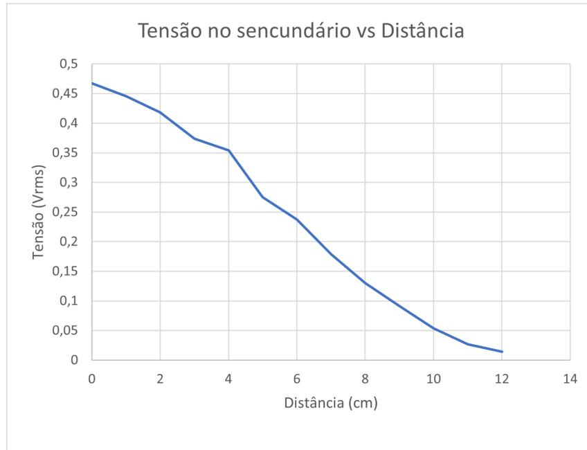
Figura 5.7: Curva tensão no secundário pela variação na distância obtida a partir da Tabela 5.4.
