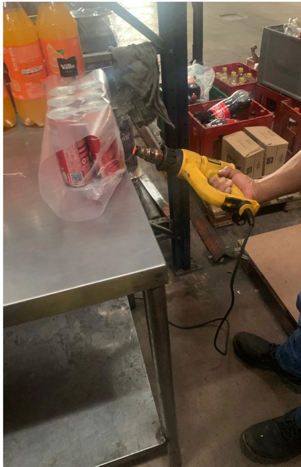
Figura 1.9: Utilização do soprador de calor para conformação e selagem do plástico filme.
