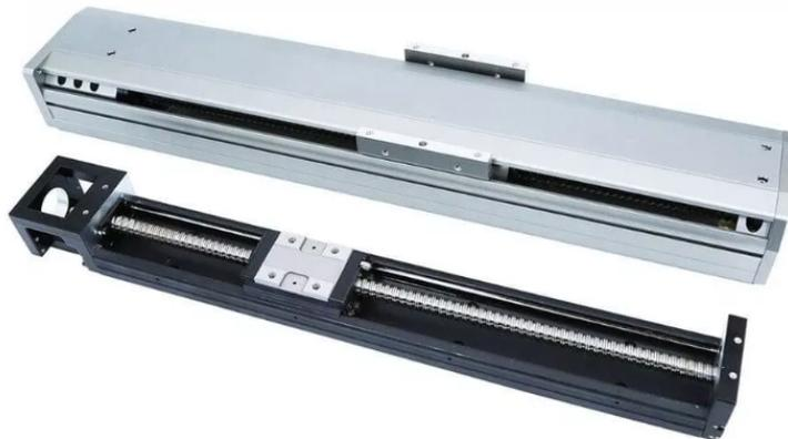
Figura 2.3: Fuso trapezoidal de um atuador elétrico.
