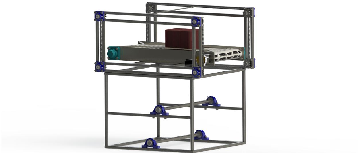
Figura 4.28: Modelagem do suporte do sistema de envolvimento.
