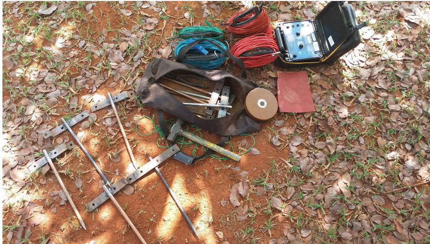
Figura 59: Materiais e equipamentos utilizados na medição de resistência
