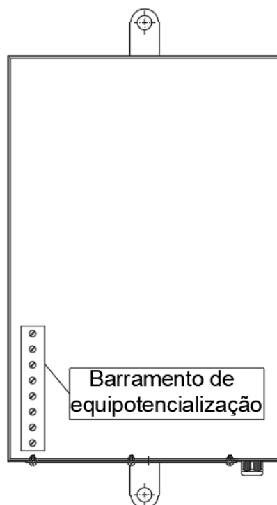
Figura 76: Quadro de comando com barramento de equipotencialização
