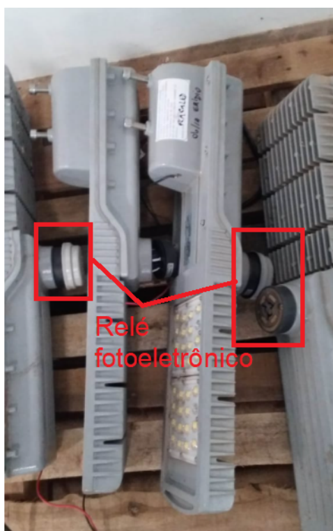
Figura 19: Relé fotoeletrônico instalado na luminária
