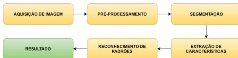
Figura 3.3: Fluxo de um sistema baseado em visão computacional - Fonte: [3]
