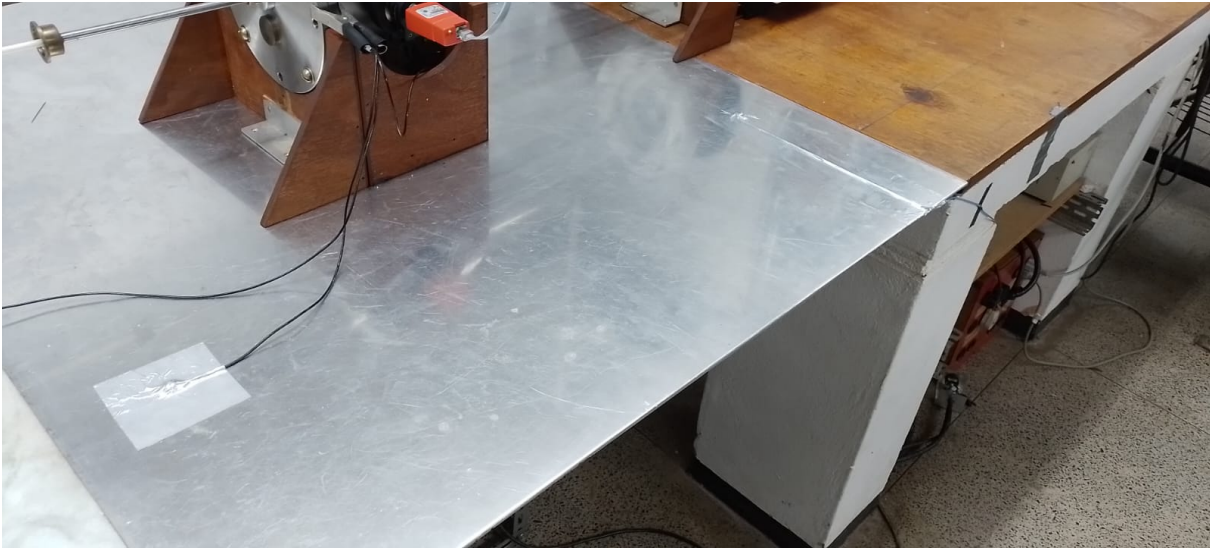
Figura 27 – Aterramento na mesa de metal. Fonte: LFP - UnB
