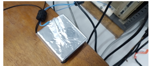
(b) Caixa que contém o resistor usado para casamento de impedância. Fonte: LFP-UnB
