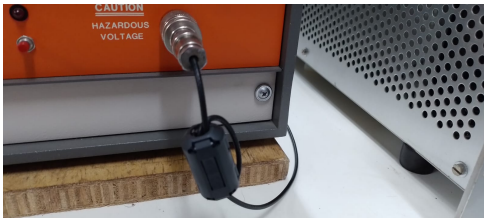
(a) Exemplo de ferrite usada no sistema. Fonte: LFP - UnB
