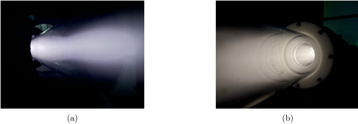
Figura 36 – Cuspide magnética formada pelo HPT. Fonte: LFP - UnB
