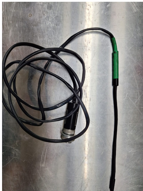
Figura 31 – Sonda para medida do campo axial. Fonte: LFP - UnB
