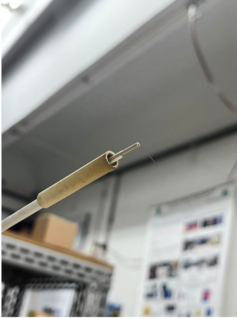
(a) Parte da sonda que fica exposta ao plasma, possuindo 0.5\text{ cm} de comprimento e 0.3\text{ mm} de diâmetro. Fonte: LFP - UnB.
