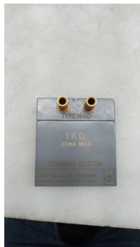
(a) Resistor shunt utilizado na medida. Fonte: LFP - UnB
