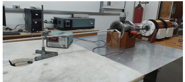
(b) Montagem experimental para caracterização do campo magnético. Fonte: LFP - UnB
