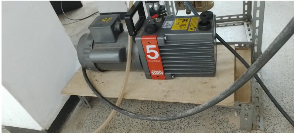
Figura 19 – Bomba mecânica da Edwards utilizada no sistema de vácuo. Fonte: LFP - UnB
