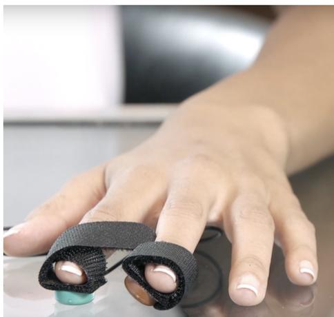
Figura 4.2: Sensor simples e evasivo para obter o sinal GSR [20].
