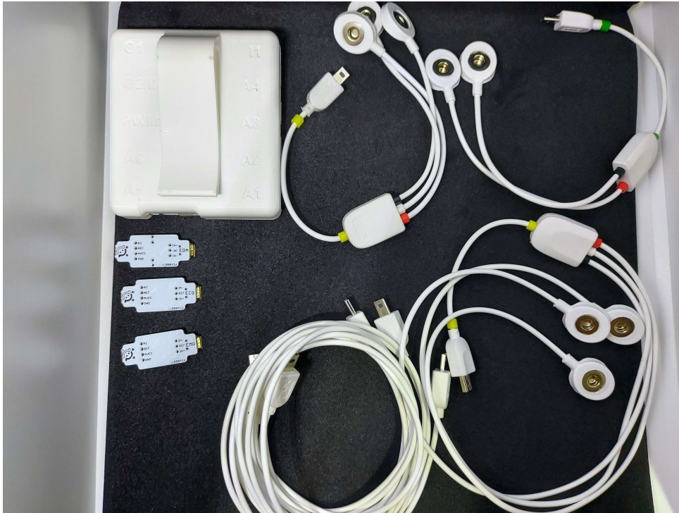
Figura 4.6: Imagem do aparelho utilizado neste estudo junto aos 3 sensores (EDA, EMG, ECG)
