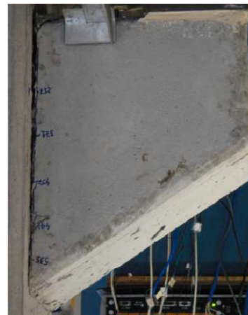
(d) Ruptura por cisalhamento na interface
