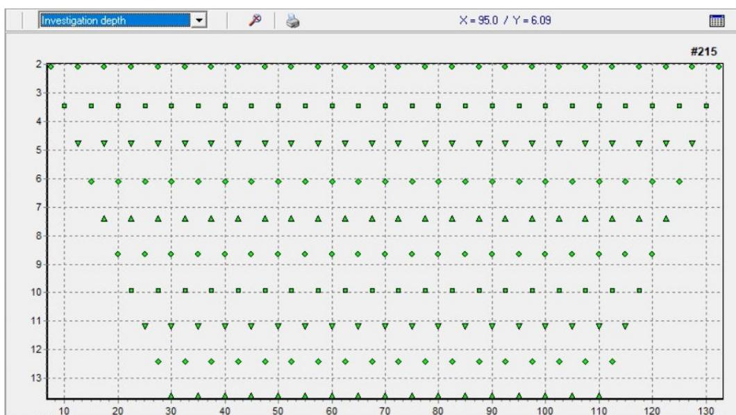
Figura 4.7 – Configuração da linha L1' (5 metros) e posição dos pontos de medidas.
