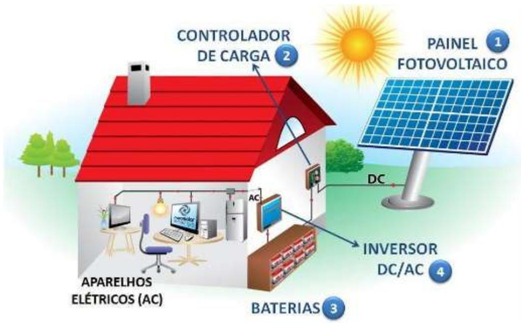
Figura 10 - Funcionamento do Sistema Off Grid (2023) Extraído de: Google Imagens: <https://www.neosolar.com.br/aprenda/saiba-mais/sistemas-de-energia-solar-fotovoltaica-e-seus-componentes> (acesso em 10/07/2023)
