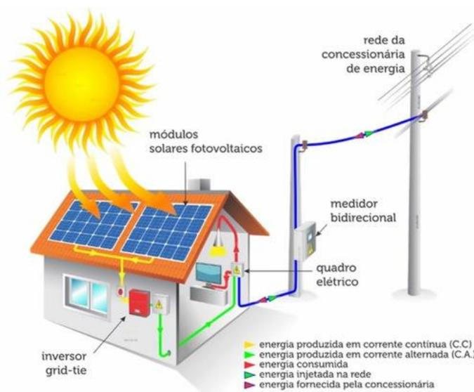
**Figura 9 - Funcionamento do Sistema On Grid (2023) Extraído de: Google Imagens: <https://goldenergy.com.br/sistema-solar-on-grid-entenda-como-funciona-a-geracao-de-energia-ligada-a-rede-eletrica/> (acesso em 08/07/2023)**
