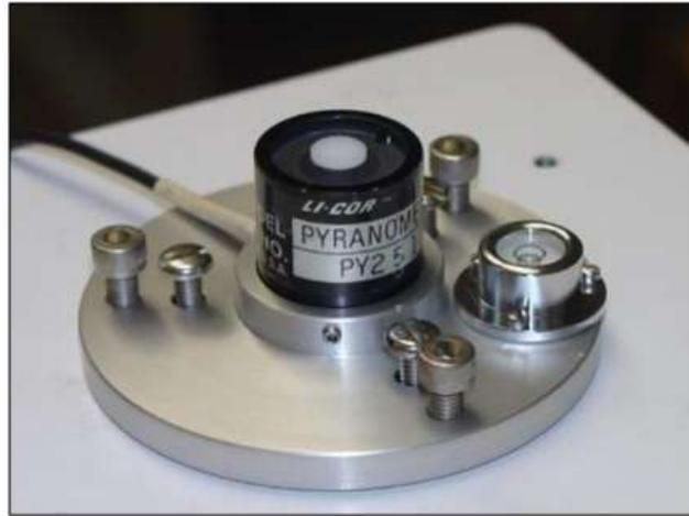
Figura 4 – Piranômetro fotovoltaico. Fonte: (Pinho; Galdino, 2014)
