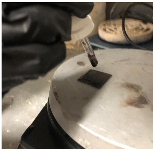
Figura 26: Deposição do \text{MnO}_2 na célula 5.
