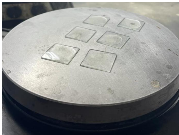
Figura 23: Substratos de vidro na chapa aquecedora.
