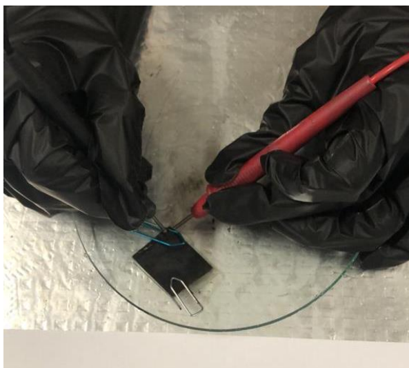
Figura 27: Medida da tensão de circuito aberto na célula 5.
