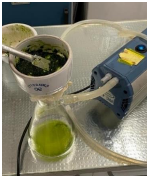
Figura 17: Amostra de clorofila+DMSO sendo filtrada.
