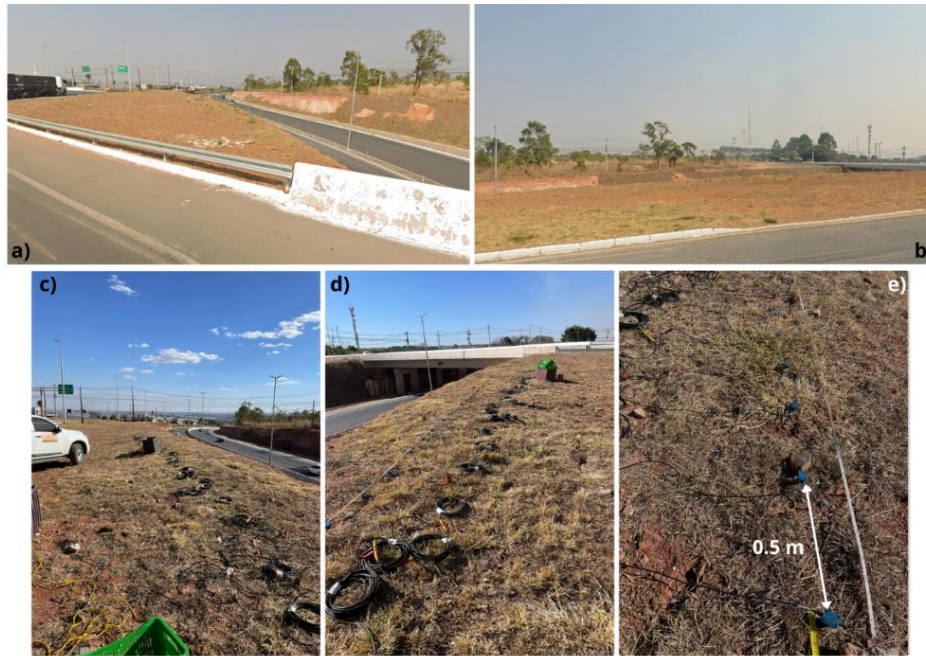
Figura 11 - Área de investigação sísmica de campo com a linha de aquisição sísmica configurada em geometria linear registrada em 18 de agosto de 2022, com as imagens a e b ) representando a área de estudos, c e d ) o início e fim do perfil sísmico na borda do talude e e ) espaçamento fixo entre os geofones.
