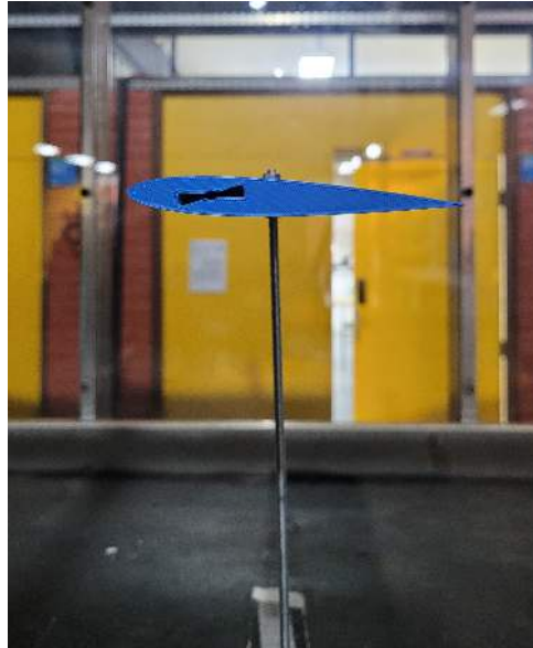
Figura 31 – Seção de asa montada no túnel de vento.
