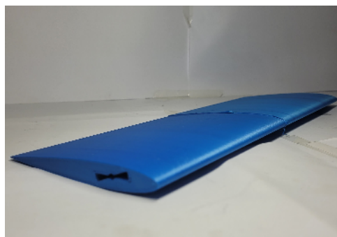
Figura 30 – Seção de asa com perfil NACA 0012 utilizada na validação da sustentação e momento de arfagem.
