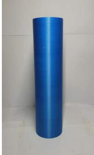
Figura 28 – Cilindro utilizado na validação do coeficiente de arrasto.
