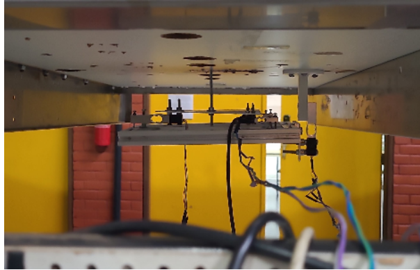
Figura 26 – Balança instalada no túnel de vento.
