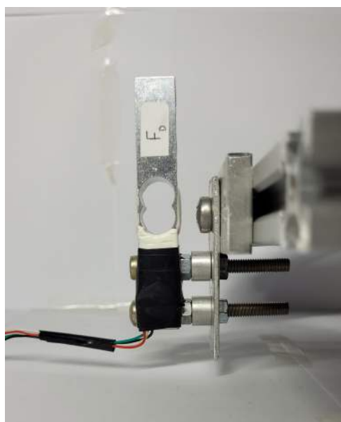
Figura 15 – Sensor F_D montado na base principal.
