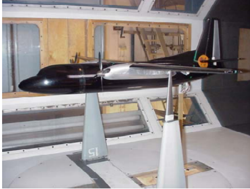
Figura 18 – Modelo Fokker F27. Maquete no Túnel de vento de baixa velocidade da universidade Delft
