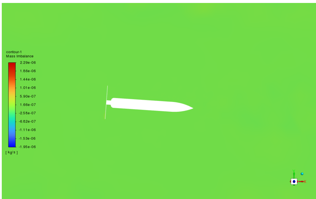
Figura 43A - Resultado dos resíduos de continuidade; SST k-\omega ; sem vórtice; AoA 4°; PROWIM.
