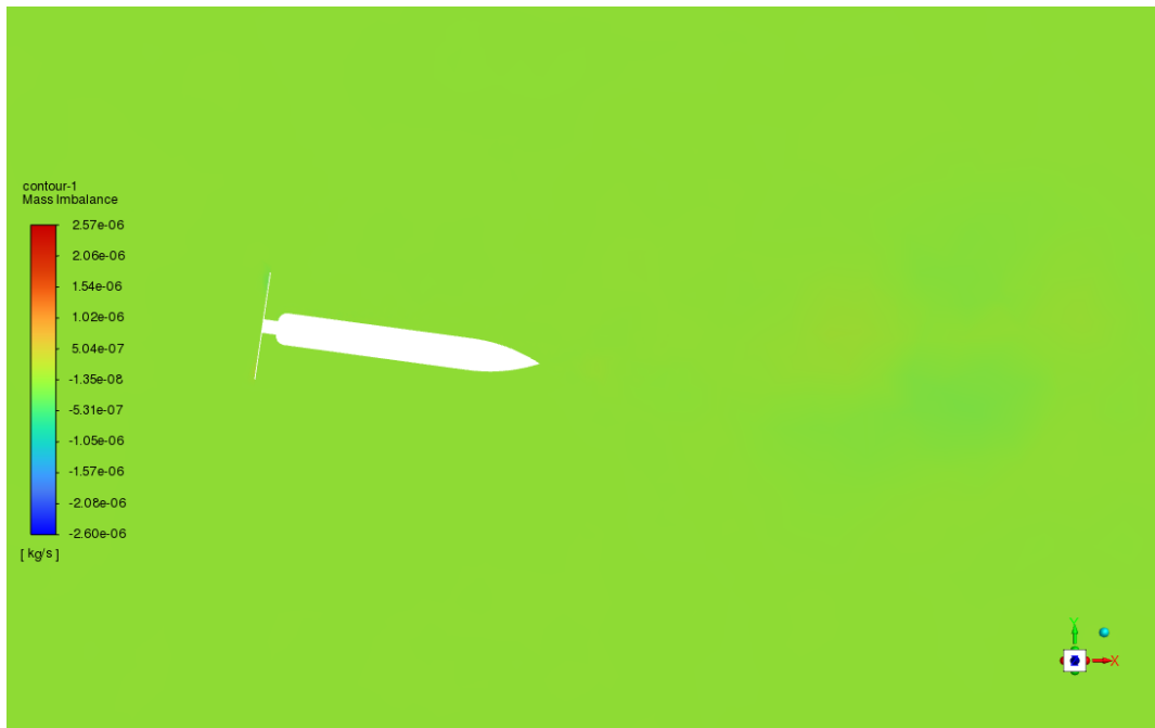
Figura 44A - Resultado dos resíduos de continuidade; SST k-\omega ; sem vórtice; AoA 8°; PROWIM.
