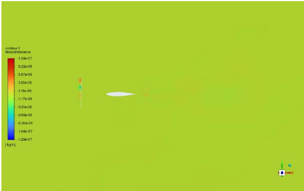
Figura 38A - Resultado dos resíduos de continuidade; inviscido; sem vórtice; AoA 0°; APROPOS.
